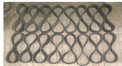
(a) 타이어셀 PC unit (b) 타이어셀 PC의 크기 (c) 타이어셀 PC
