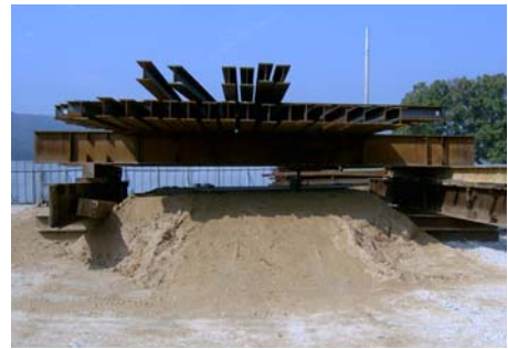
(b) 상재하중을 이용한 하중재하방법
