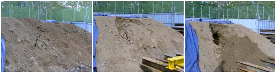
그림 55 인발시험에 의한 단계별 사면파괴사진 (트레드매트 6×6(A), 성토고 1.5m)
