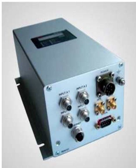
그림 1-2 REM(Railway Energy Meter)시스템 사진 및 구성도
