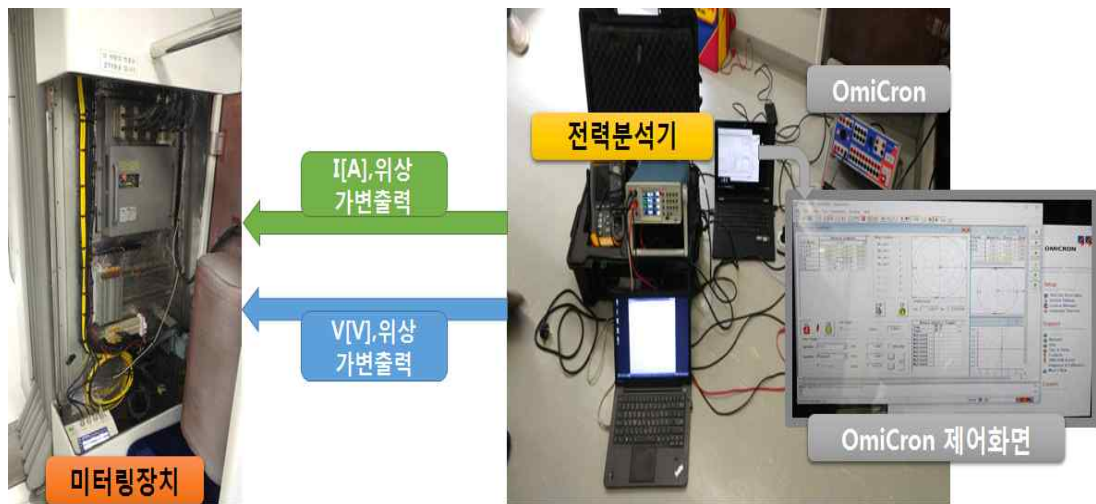
그림 1-8 시제품과 전력분석기 시험
