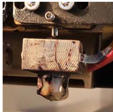
그림 6. 높은 노즐온도로 인한 고분자 필라멘트의 누출 및 Droplet 발생현상
