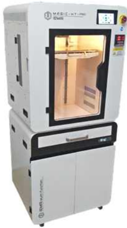
그림 2. 듀얼노즐 3D 프린터(IEMA)
