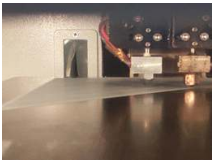
그림 18. 300x300x13 mm 3 치수로 Macroscale로 설계된 단열재의 3D 프린팅 공정
