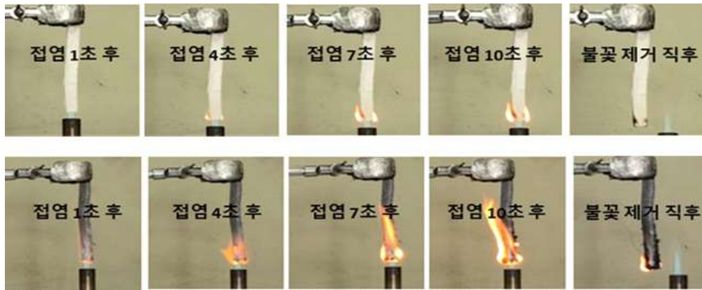
그림 25. (상단) 현재 개발 중, (하단) 타 유기난연제 사용 V-0급 난연 복합소재의 수직난연시험
