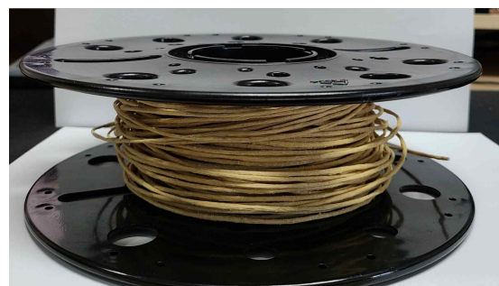
그림 31. PK/IFR/MOSw 복합소재의 3D 프린팅용 필라멘트
