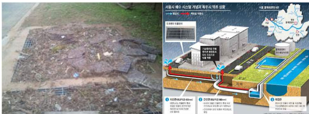
그림 1.11 부족한 배수 인프라로 인한 폭우시 역류 상황(방재안전관리연구센터, 2011)
