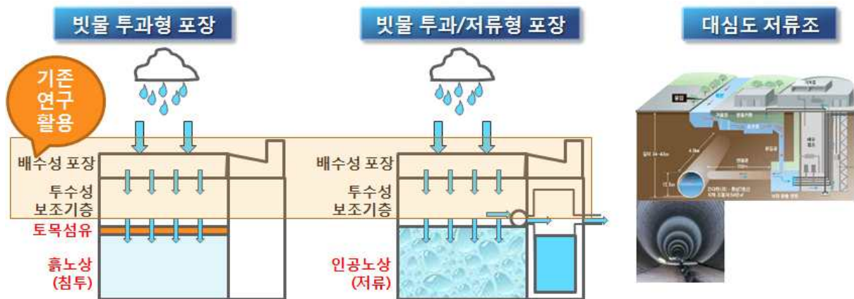
그림 1.17 기존의 투수성 포장과 투수/저류형 포장의 차이점
