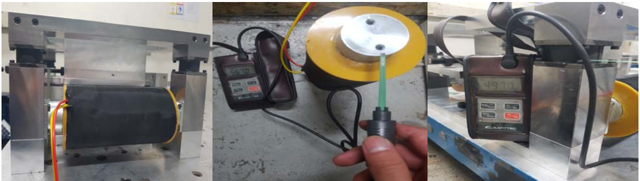
그림 3.17 제작된 전자석 시스템 및 측정결과 (코일 표면 자기장 : 0.56T, MRE 측면 : 0.49T)
