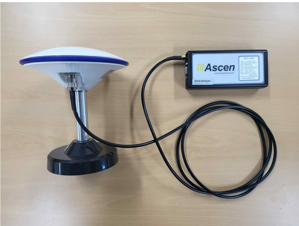
<그림 2.174> GPS 수신기와 케이블로 연결된 GPS 안테나
