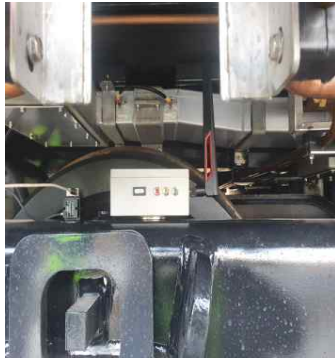
<그림 2.107> WA-PMS 무선가속도센서 부착 및 데이터 측정
