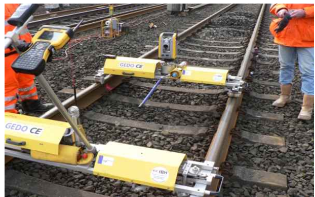
<그림 1.5> GEDO 궤도선형 측정 장비
