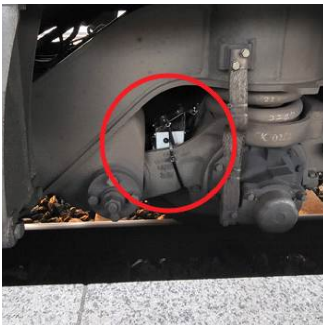
<그림 2.155> 시험당일 KTX-017열차에 장착된 무선가속도계 우측(좌) 좌측(우)
