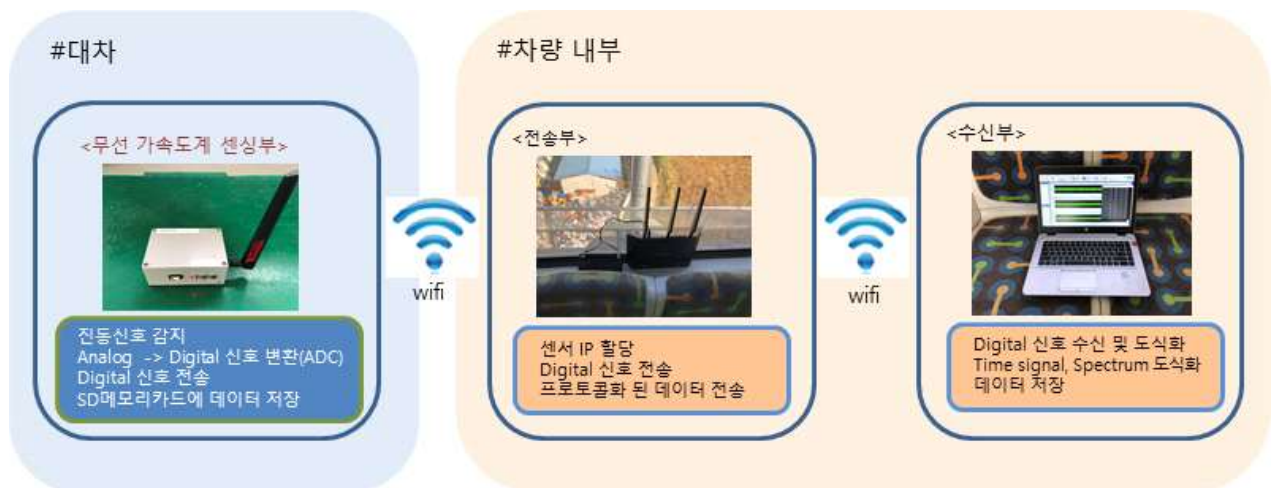
<그림 2.100> WA-PMS 무선 가속도계의 데이터 전송 플로우
