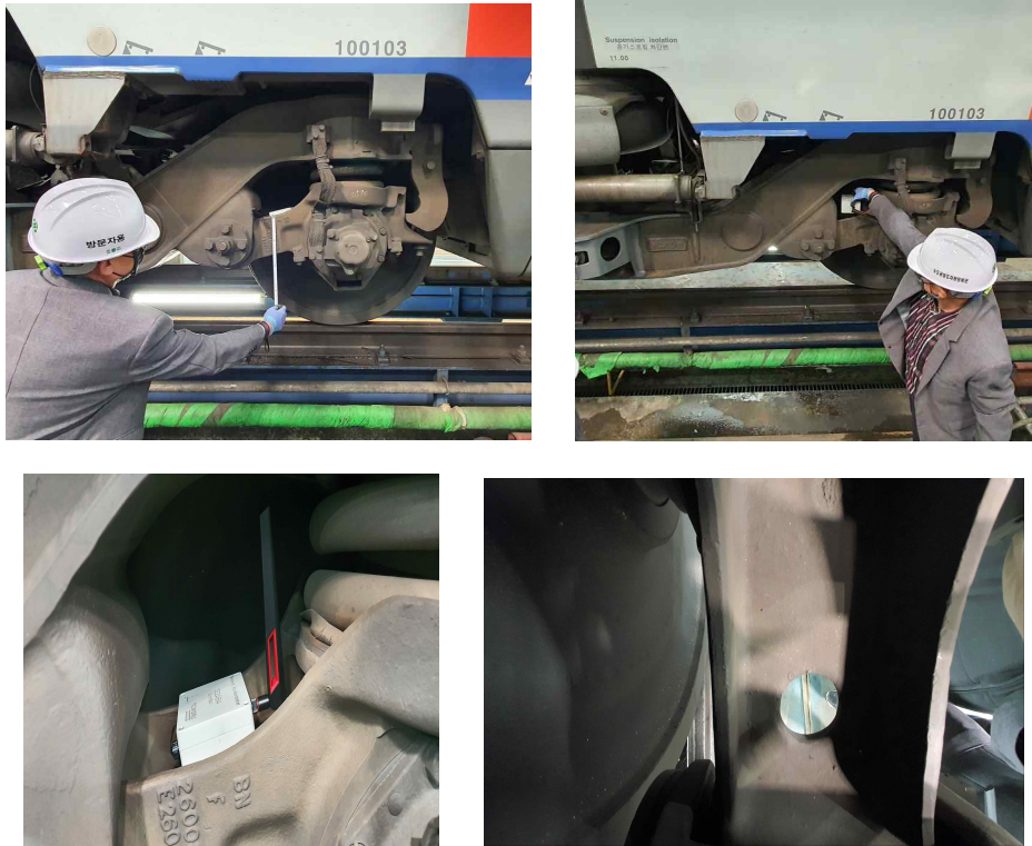
<그림 2.147> 무선가속도계 설치 위치 및 방법
