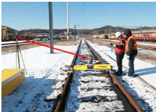
<그림 1.5> GEDO 궤도선형 측정 장비
