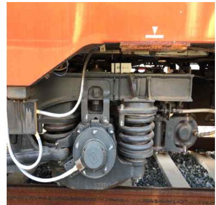
<그림 2.102> WA-PMS 무선가속도센서 부착 및 데이터 측정>
