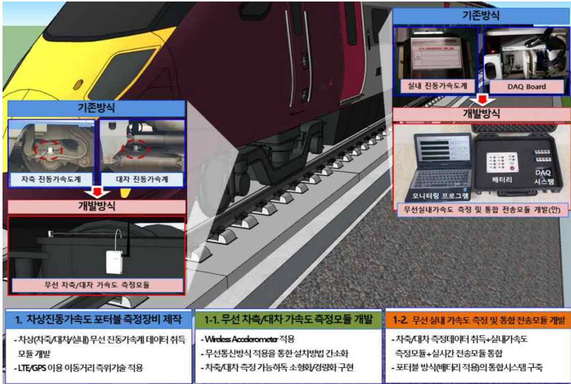
<그림 1.11> 무선 가속도계를 이용한 이동형 철도 궤도결함 고속 측정 시스템(WA-PTMS 1) ) 개발
