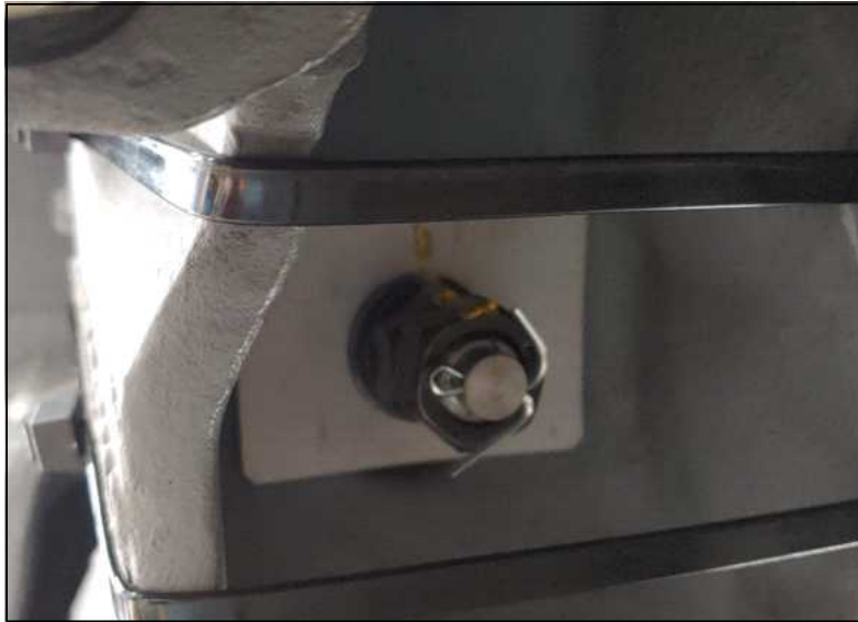
<그림 2.164> 무선가속도계 센서 고정 방안
