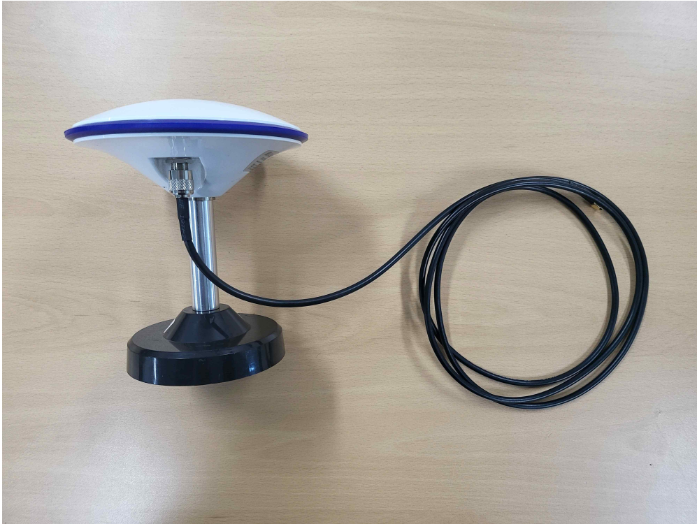
<그림 2.173> GPS 안테나-GPS 수신기 연결케이블이 장착된 GPS 안테나
