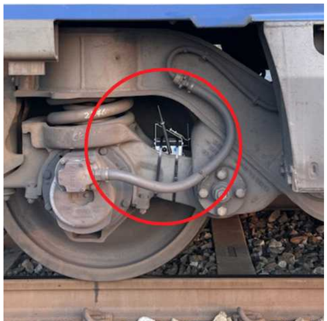
<그림 2.155> 시험당일 KTX-017열차에 장착된 무선가속도계 우측(좌) 좌측(우)
