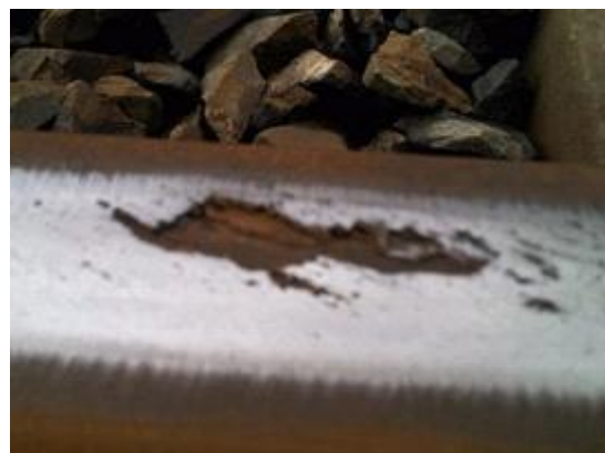
<그림 2.10> 스폐링(Spalling) 발생 사진
