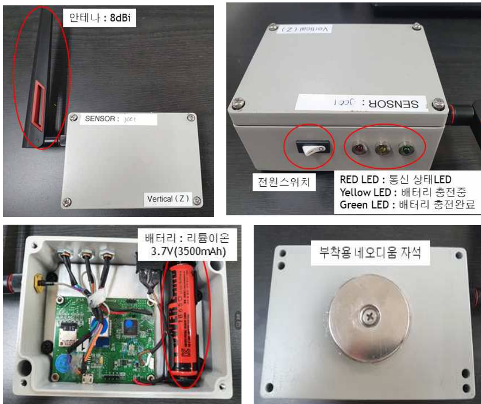
<그림 2.97> WA-PMS 무선가속도센서 내·외관
