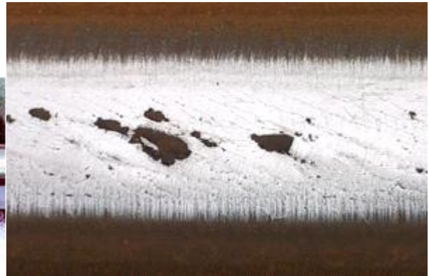
<그림 2.9> 헤드체크(Head Checks) 발생 사진
