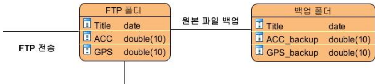
<그림 2.116> 이력정보 클라우드-DB 스키마 설계도 중 데이터 전송 부
