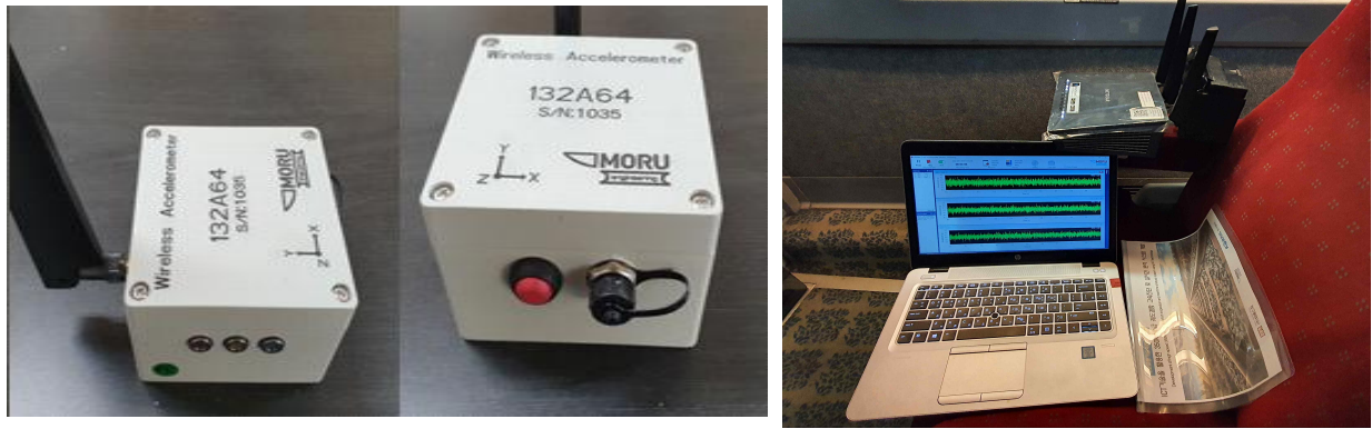
<그림 2.144> 무선 가속도계 및 데이터 측정 시스템
