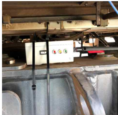
<그림 2.102> WA-PMS 무선가속도센서 부착 및 데이터 측정>
