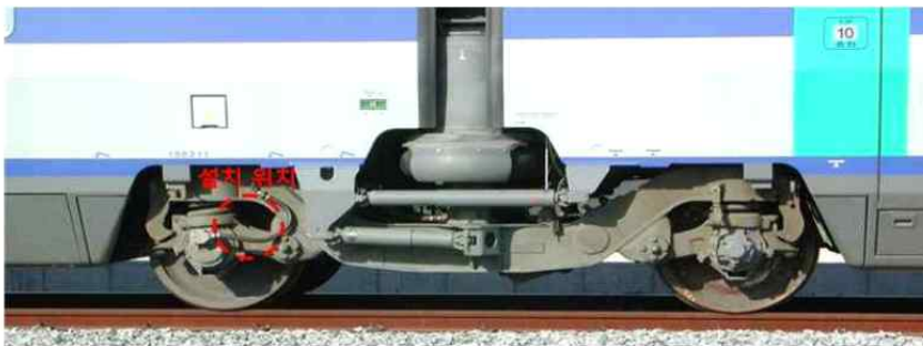
무선가속도계 설치 위치 <그림 2.148> 무선가속도계 설치 위치
