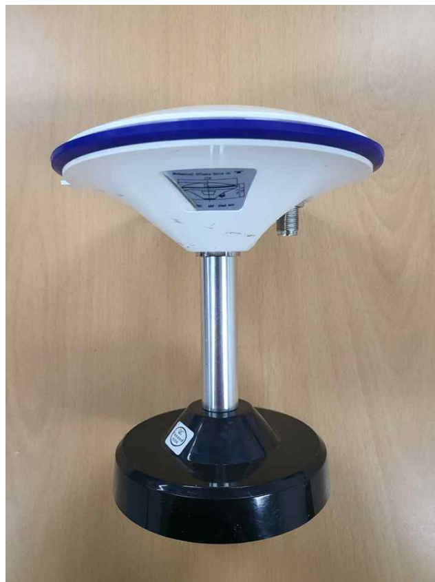
<그림 2.172> 조립 완료된 GPS 안테나
