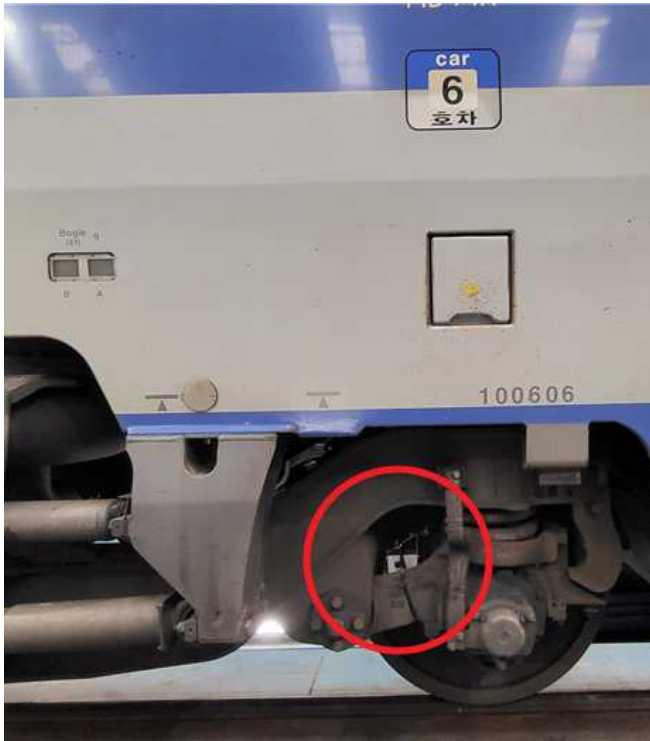
<그림 2.154> KTX-006호에 장착된 무선가속도계 우측(좌) 좌측(우)
