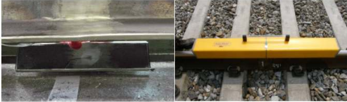
<그림 2.5> 레일휨응력 센서 설치 전경 <그림 2.6> 레일표면요철 계측 전경
