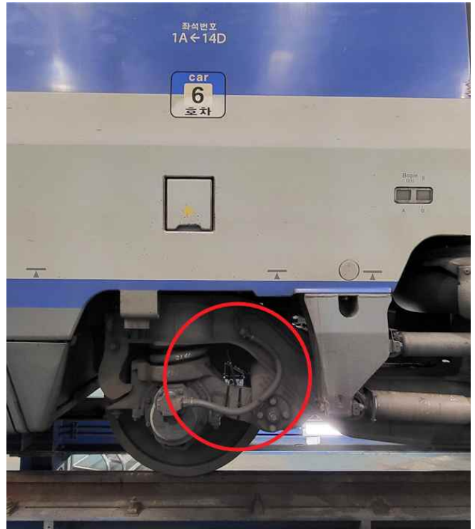
<그림 2.154> KTX-006호에 장착된 무선가속도계 우측(좌) 좌측(우)
