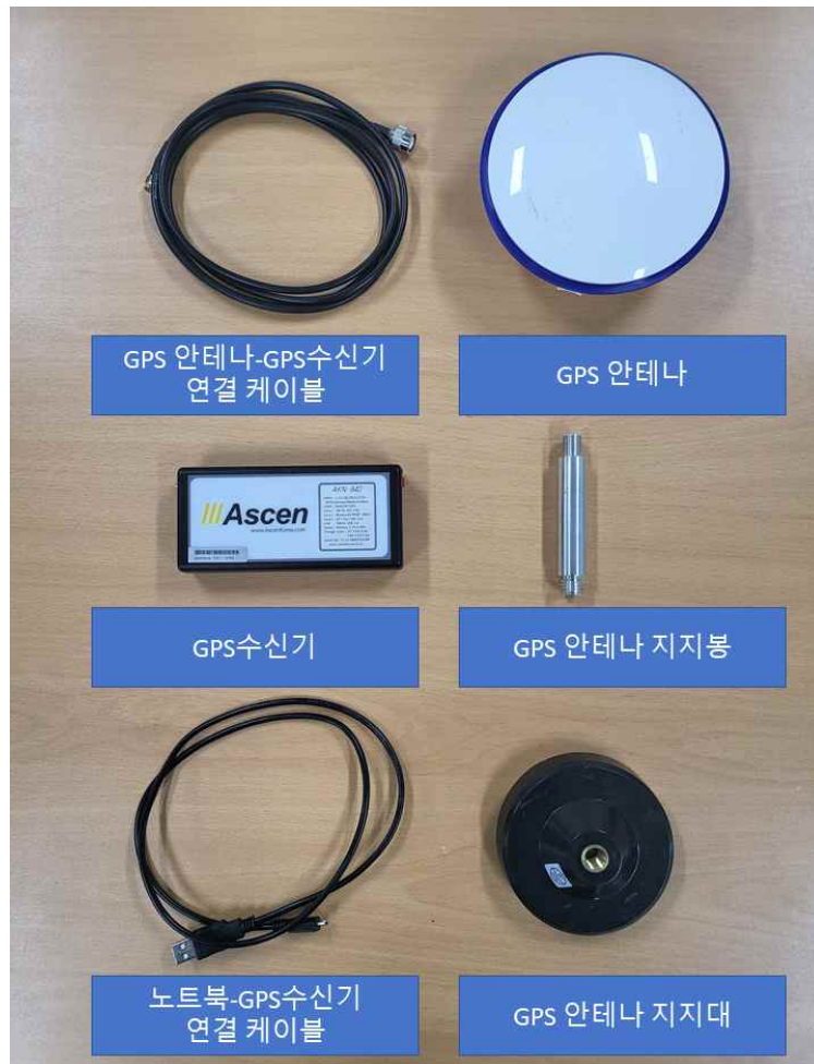
<그림 2.171> GPS 측정 구성품
