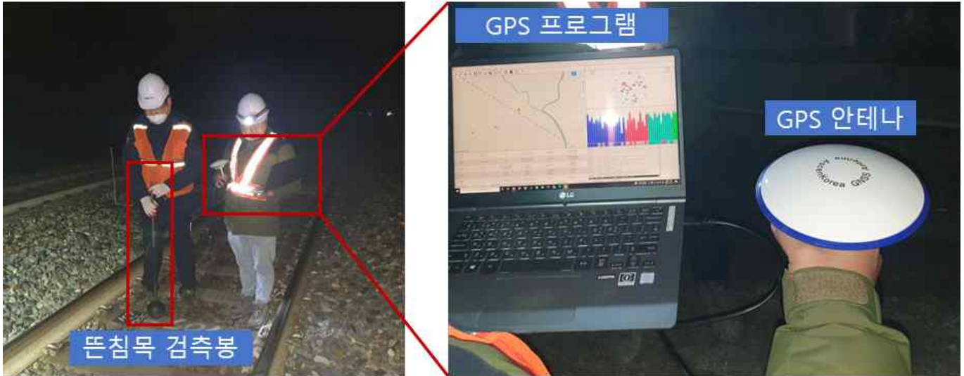
<그림 2.151> 뜯침목 검측봉을 활용한 뜯침목 발생위치 확인
