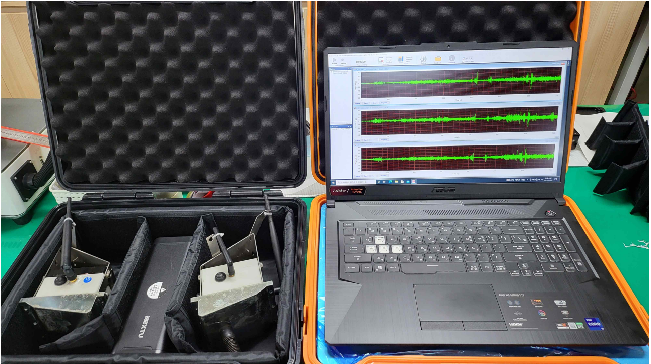
<그림 2.135> LTE기반 실시간 전송모듈
