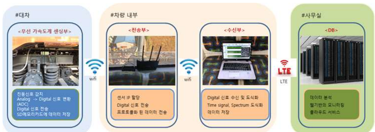
<그림 2.141> WA-PMS 무선가속도센서 데이터 전송 흐름도
