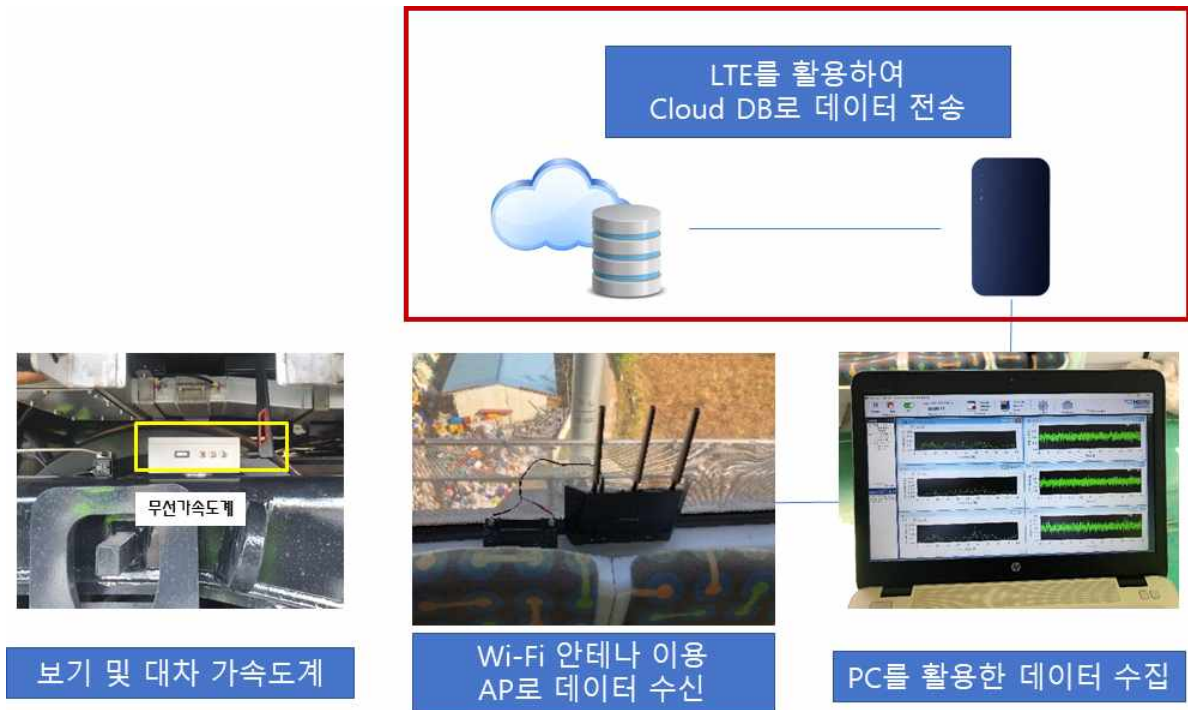
<그림 2.145> 무선 가속도계를 이용한 포터블형 궤도결함 측정 시스템(WA-PTMS) 최종 구성
