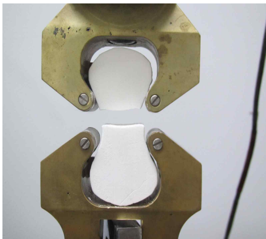
<그림 3.14> 구조안전성 확인을 위한 인장 및 전단강도시험
