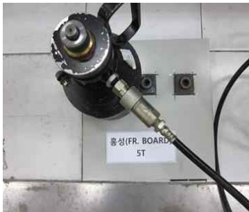
부착강도시험기 지그 설치
