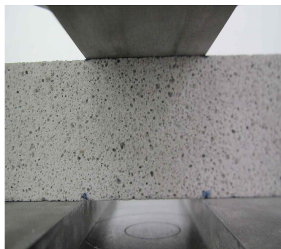
<그림 3.14> 구조안전성 확인을 위한 인장 및 전단강도시험
