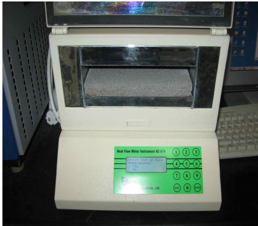
<그림 3.12> 열전도율 측정 및 밀도측정
