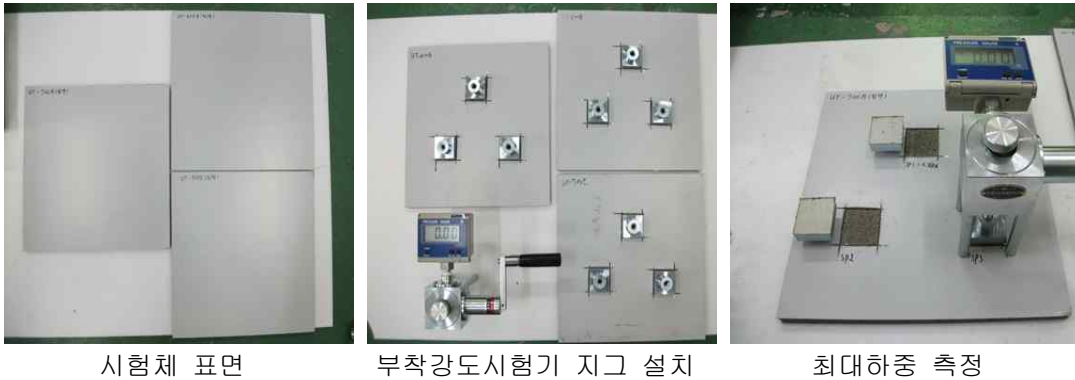
<그림 3.66> 부착강도 시험 과정
