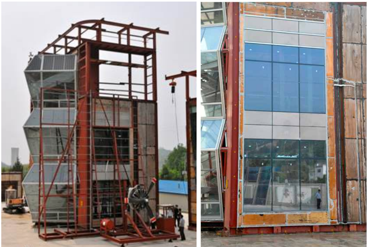
<그림 3.90> 커튼월 Mock-up 시험
