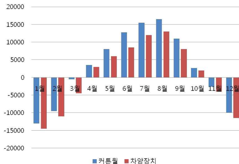
그림 4 커튼월 수직 차양 장치를 적용하기 전과 후의 냉난방 부하 비교 (단위: kcal/h)
