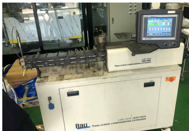
그림 가-8 트윈압출기(Bautak BA-19)
