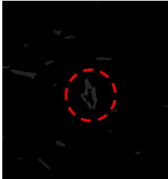
그림 다-34 내부가 꽉 차지 않은 군집 CNC로 인한 종횡비 측정 오차 발생(Micro-CT 분석)
