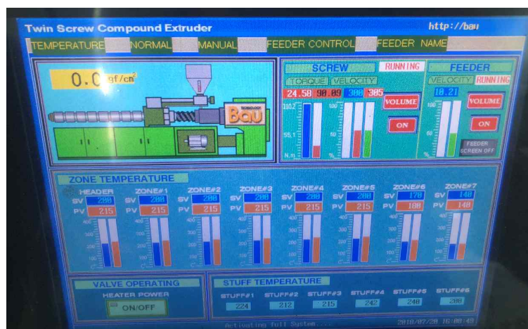
그림 가-9 트윈압출기 zone 별 온도 세팅 및 작동 세팅 파라미터
