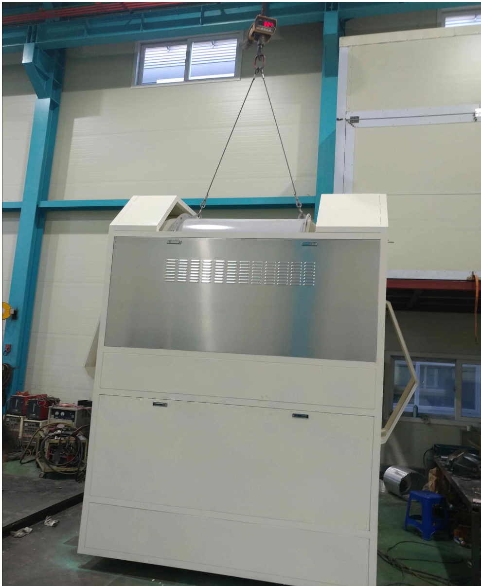
그림 3.3.5 안개제거장치 시제품 무게 측정
