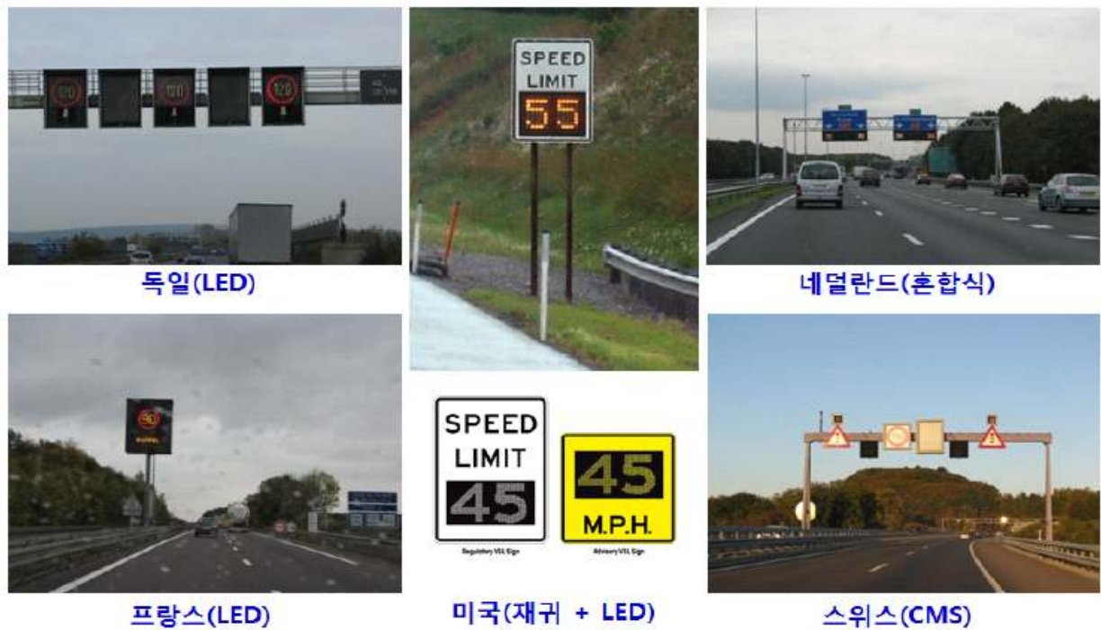
그림 6.1.1 해외의 VSL 설치 사례
