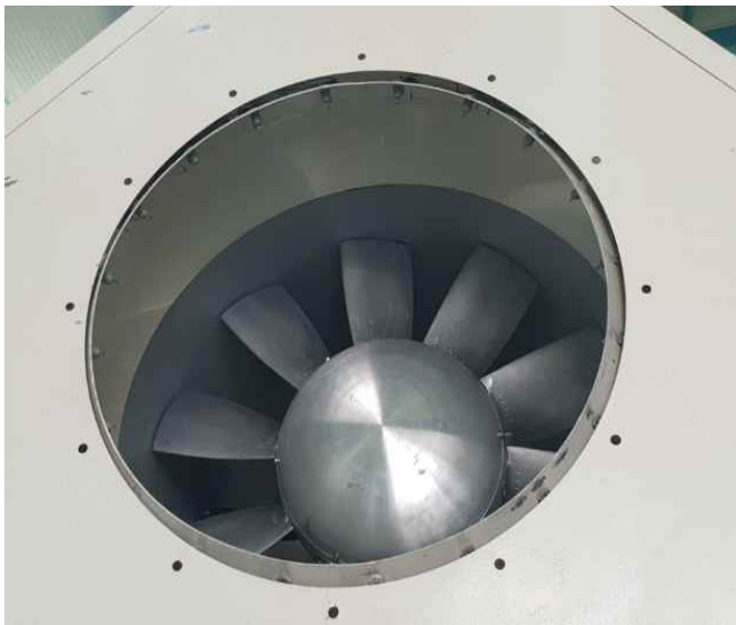
그림 3.4.19 안개제거장치 내부 송풍장치
