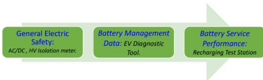
[그림 33] EV 3 STEP TEST 프로세스
