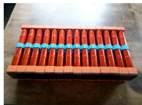
[그림 28] Voltek Hybrid & EV Repair社の 열화 배터리 셀 진단 및 교체
