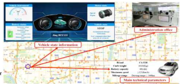
[그림 39] BIT의 빅데이터 기반 전기자동차 모니터링 플랫폼 사용 예시
