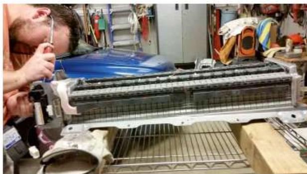
[그림 28] Voltek Hybrid & EV Repair社の 열화 배터리 셀 진단 및 교체
