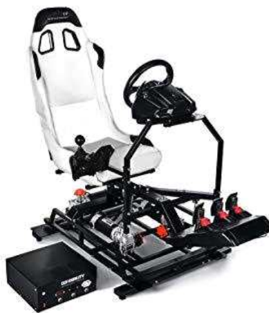
그림 2.95. 3축 의자: 의자의 기울기를 주기 위해서 필요하며, 몰입감과 극대화 하는데 필요함, 현대자동차의 경우, 6축 의자로 운전 시뮬레이터를 제작함.
