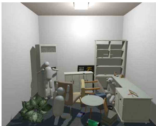
그림 2.98. 본 연구에서는 실내 공간에서 진행하여 단지 공간 자체를 흔드는 것뿐만 아니라 흔들림에 따라서 실내의 물건들이 어떻게 움직이는지도 자세하게 적혔음. 또한 실내의 구성물질의 종류와 밀도에 따라서 다르게 움직이도록 만들기도 했음.(Li et al., 2017)
