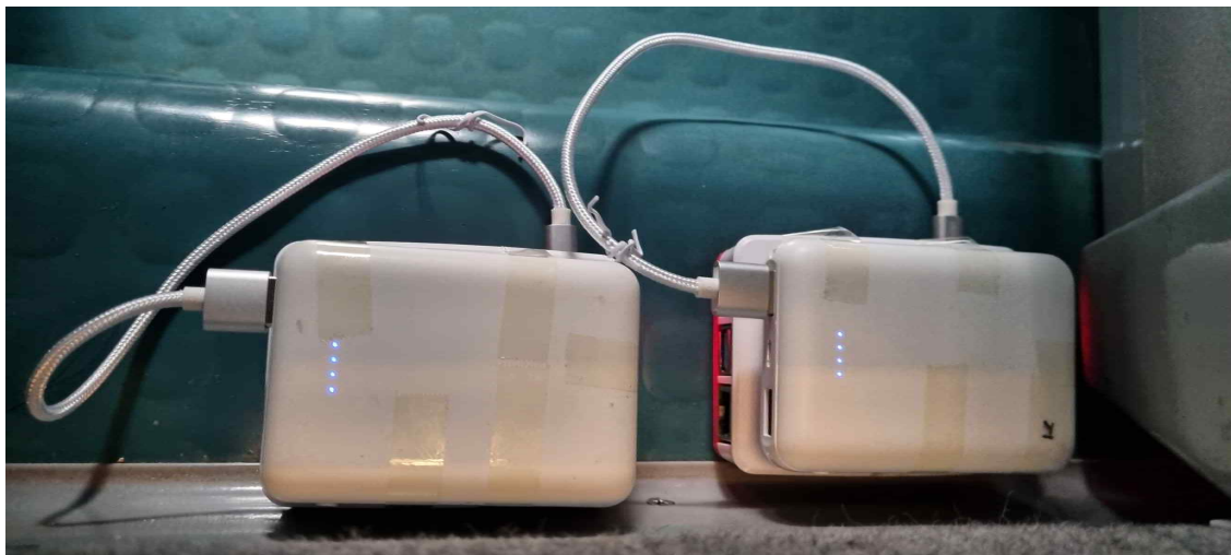
그림 2.58. 열차 객실 바닥에 고정한 지진조기경보 시스템
