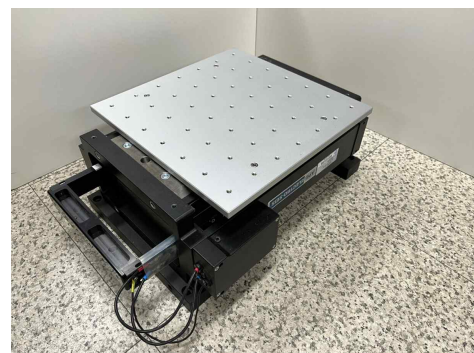
그림 2.3. 활용 진동대 사진 및 진동대 제원
