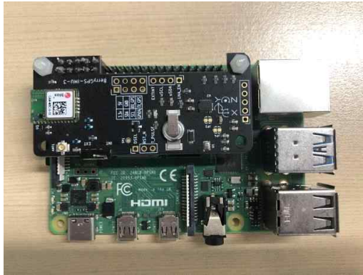
그림 2.1. 개발된 가속도 계측용 Sensor
