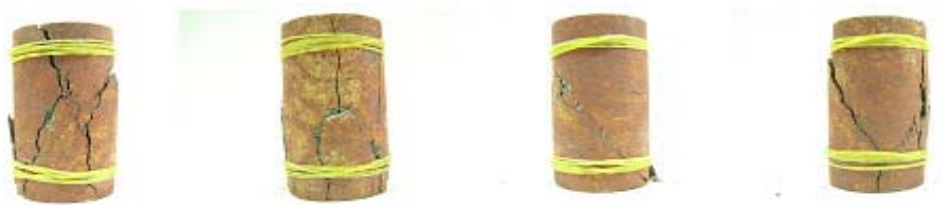
그림 43. 풍화시험 후 C 그룹의 공시체 파쇄특성.
