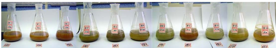
그림 61. 암석의 ABA test.
