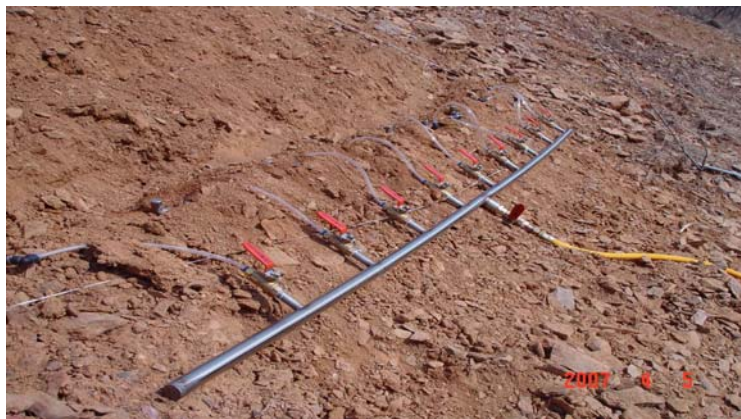
그림 89. 점적관수장치를 이용한 코팅처리제 주입.
