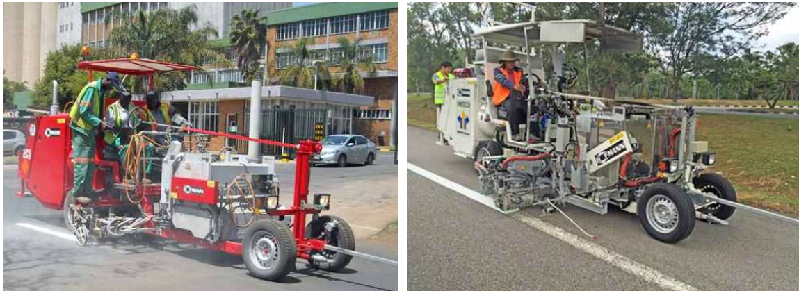
<그림 2.13> 유럽 Hofmann社 소형 차선도색 자동화 장비
