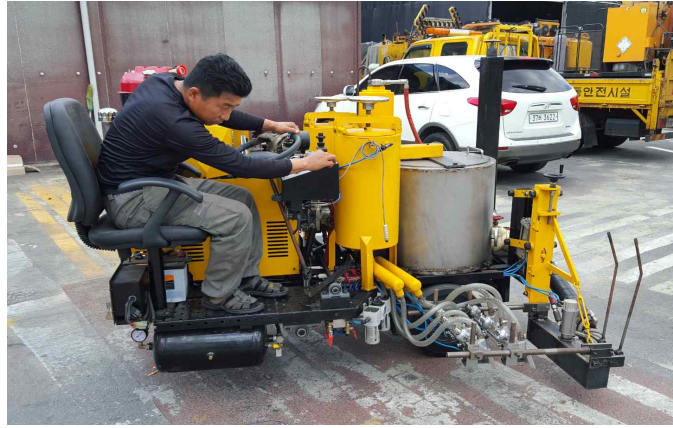
<그림 3.9> 소형 용착식 차선도색 자동화 장비
