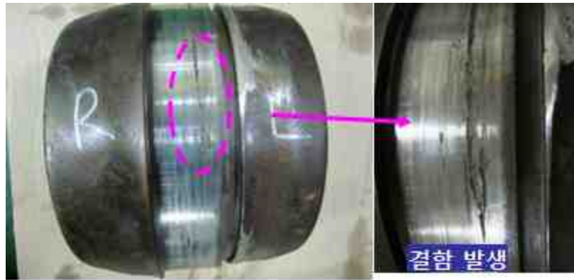
[그림 4.1.27] 디스크커터의 조립공차 부적합
