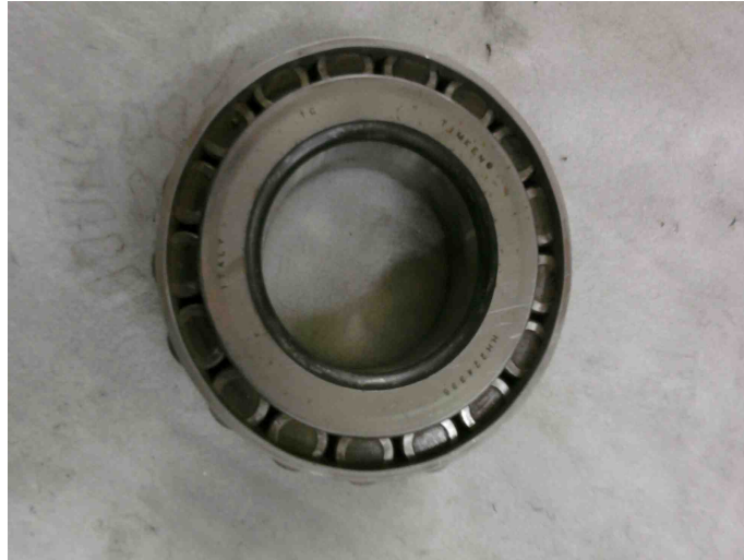
[그림 4.1.22] Herrenknecht 디스크커터에 장착된 베어링 형상 (단열, TIMKEN사)
