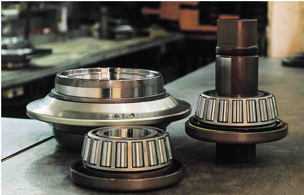
[그림 4.1.3] 재활용된 경암용 디스크커터(Herrenknecht, 2007)
