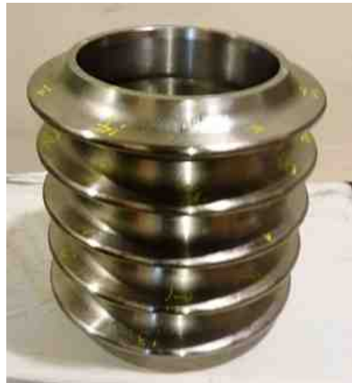
(b) 황삭 가공 후 상태
