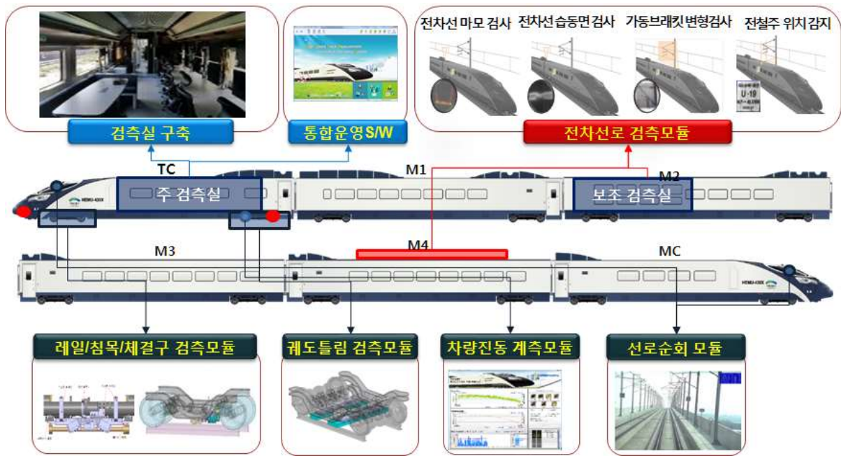
[그림 2.77] HEMU-430X 인프라 검측 시스템
