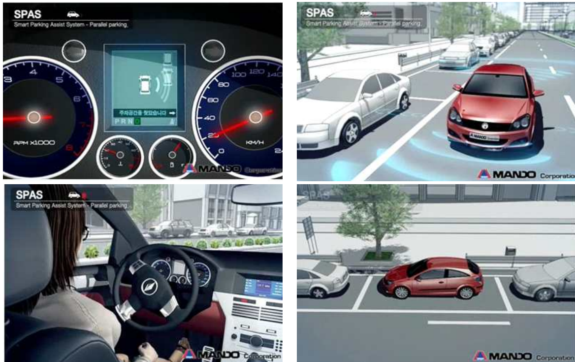
[그림 2-31] 만도에서 개발한 자동주차보조시스템 SPAS
