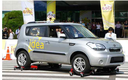
[그림 2-32] (좌) 미니주차로봇 준비단계 (우) 미니로봇 분리에 의한 차량 리프팅 모습
