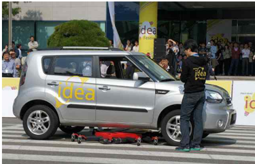
[그림 2-32] (좌) 미니주차로봇 준비단계 (우) 미니로봇 분리에 의한 차량 리프팅 모습
