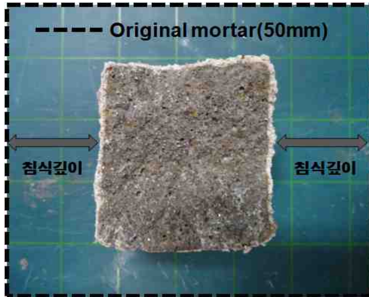
그림 3.33 HAC 대체율에 따른 침식깊이 측정방법
