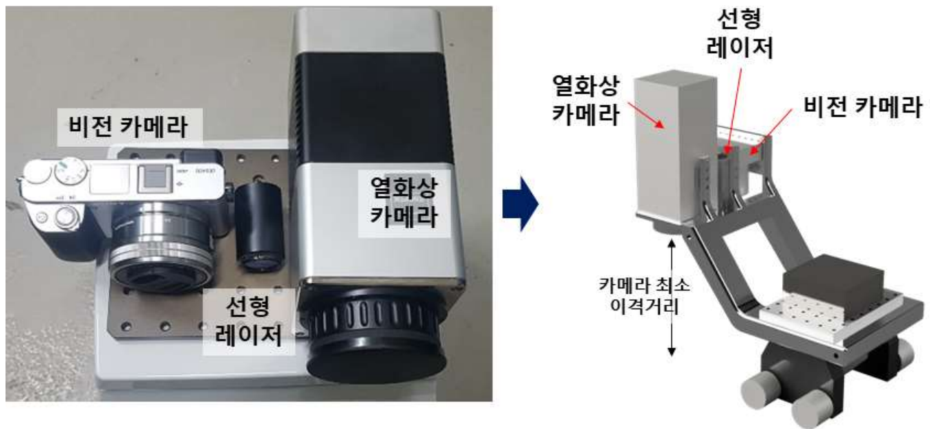
그림 22. 개발 이중 영상 시스템 개요 및 추후 프레임 부착 예시도
