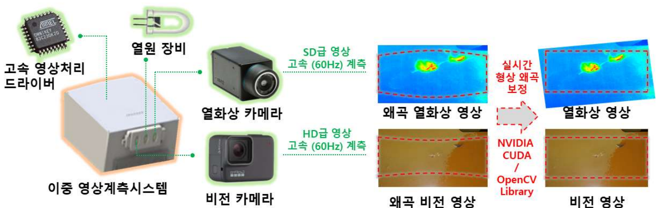
그림 14. 열화상 및 비전 기반 이중 영상계측시스템 개요
