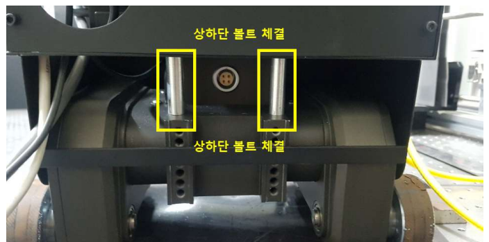
그림 46. 이동 로봇 플랫폼과 이중 영상계측장치 연결부
