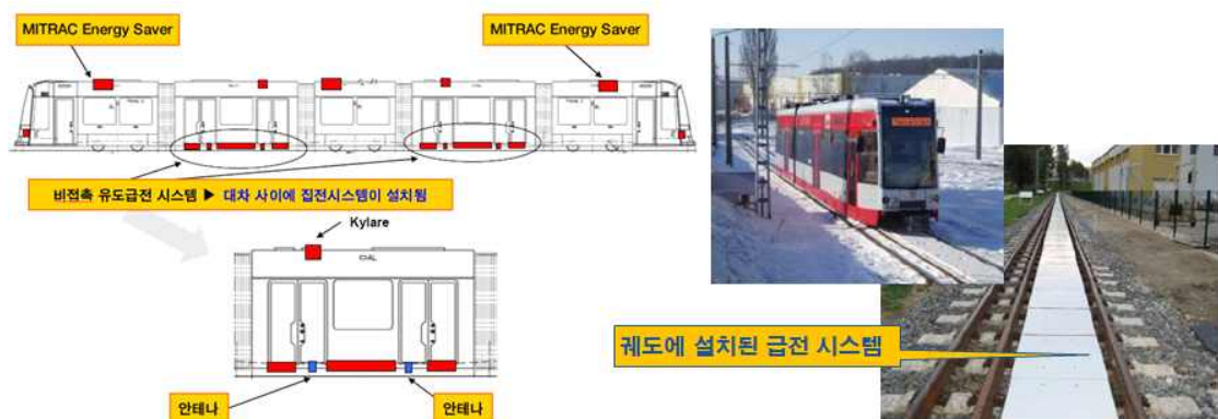
<그림 60 Bombardier의 PRIMOVE 시스템 및 독일 Bautzen의 시험라인>
