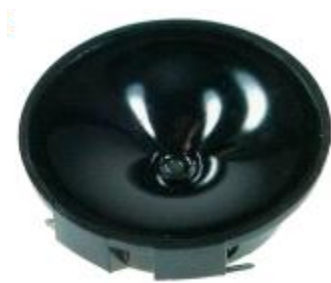
<그림 26> 적용된 초음파 스피커 및 특성자료(좌; KEMO 초음파 스피커, 우; 스피커 특성)
