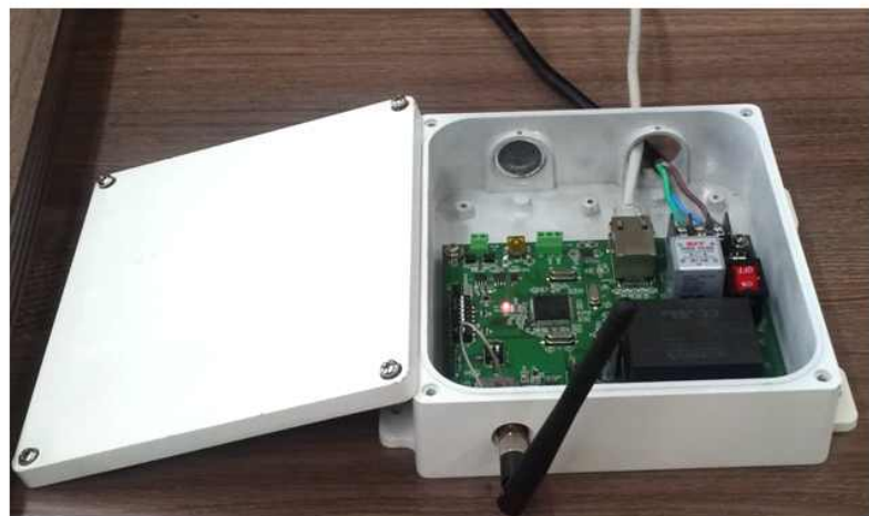
<그림 65> 메인컨트롤러 시제품 PCB 및 내부 사진
