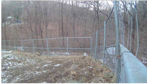
<그림 38> 2차 시제품의 고라니 반응특성 시험결과
