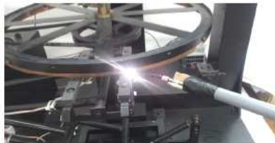
〈그림 3〉 이선 아크 검출장치 모의시험
