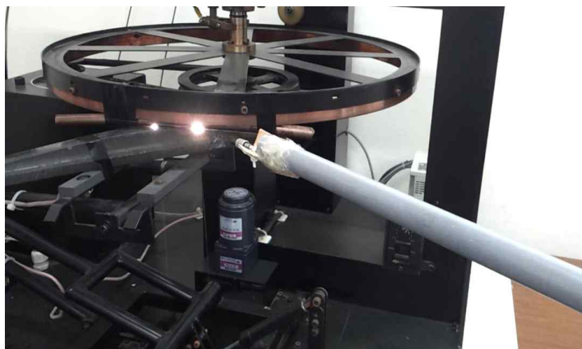
그림 88 가공전차선 - 전기기관차(8200호대) 팬터그래프 실험사진
