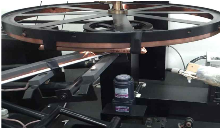
그림 80 강체가선(T bar) - 누리로 전동차 팬터그래프 실험
