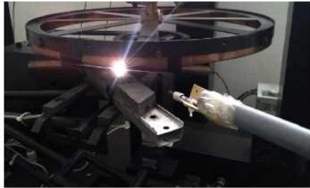
그림 5 이선 아크 검측장치 모의시험 Fig. 5 Test of the contact-loss arc detection system
