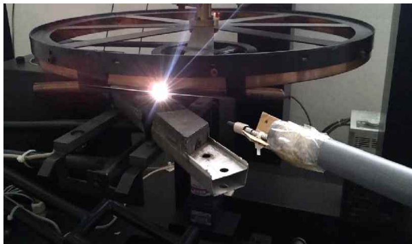
그림 86 가공전차선 - 고속철도차량(KTX1) 팬터그래프 실험
