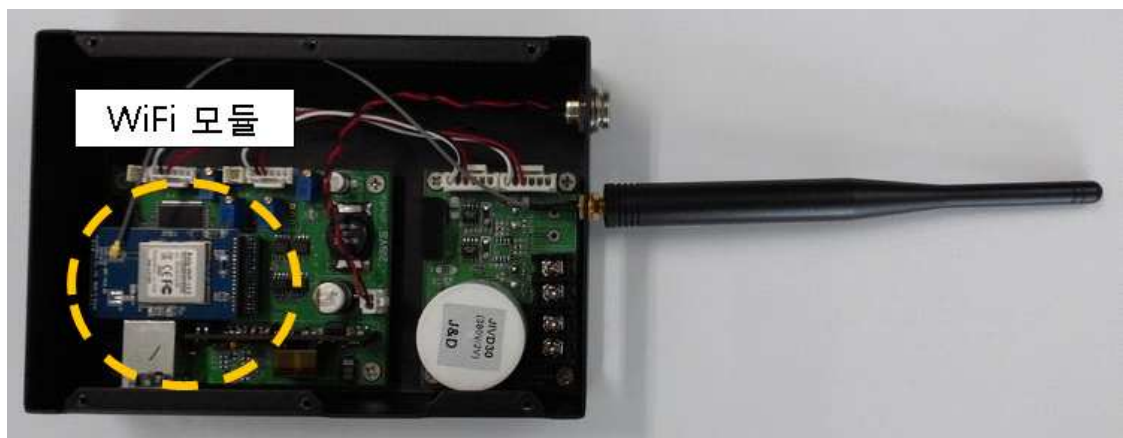
그림 111 전류식 이선 검출기 개발품 사진 (Wifi모듈 및 안테나 장착)
