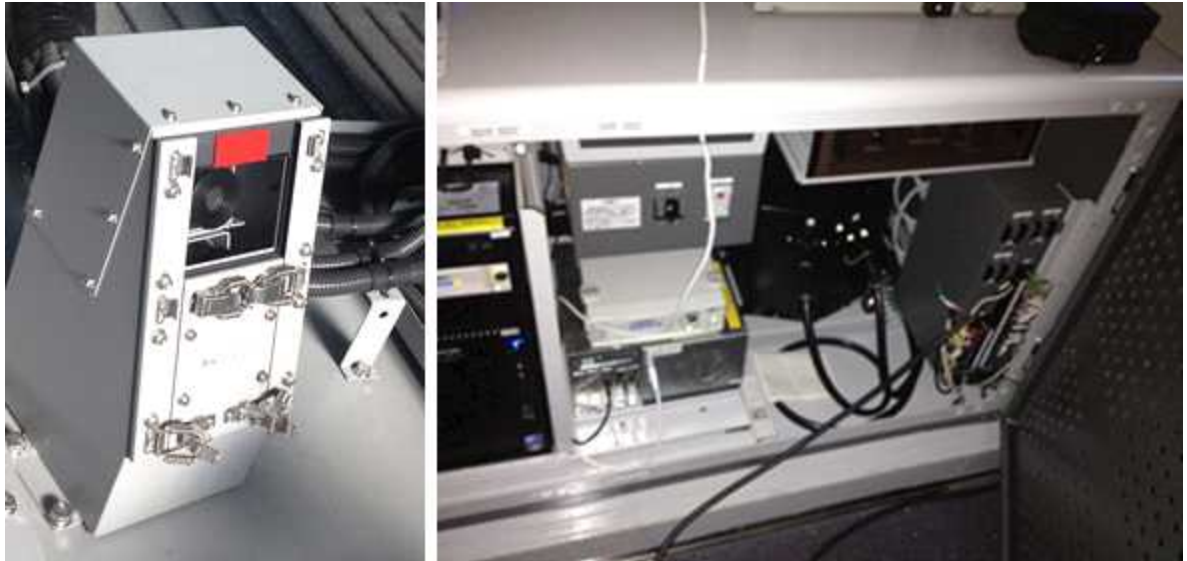
그림 27 검측 차탑 및 차상에 수광부와 검출부가 설치된 모습
