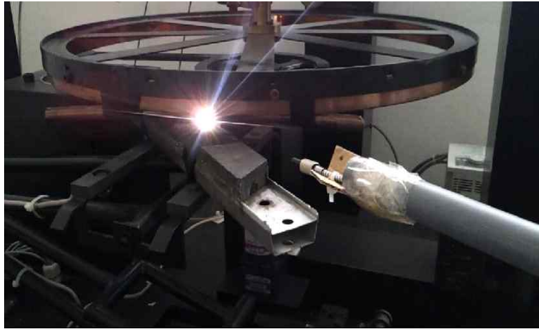
그림 74 이선 아크 검측장치 모의시험
