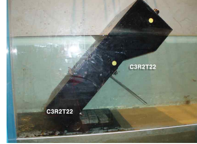
그림 3.2.5 Flap 부유형 방파제 3안 설치 장면.
