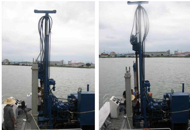
그림 3.2.5 지반조사 전용선 시추 모습
