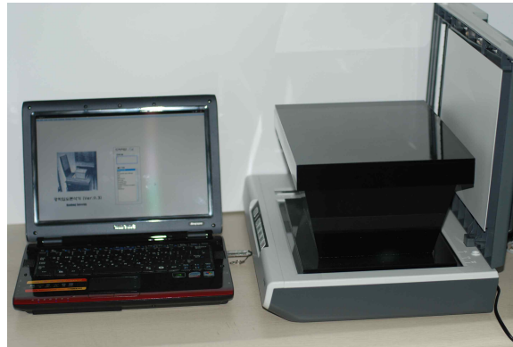
그림 3.3.10 모래입도 분석기 시제품 모습
