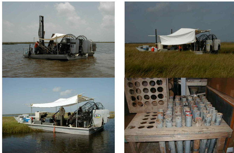
그림 3.2.3 습지 관광용 에어보트의 지반조사 사용 예
