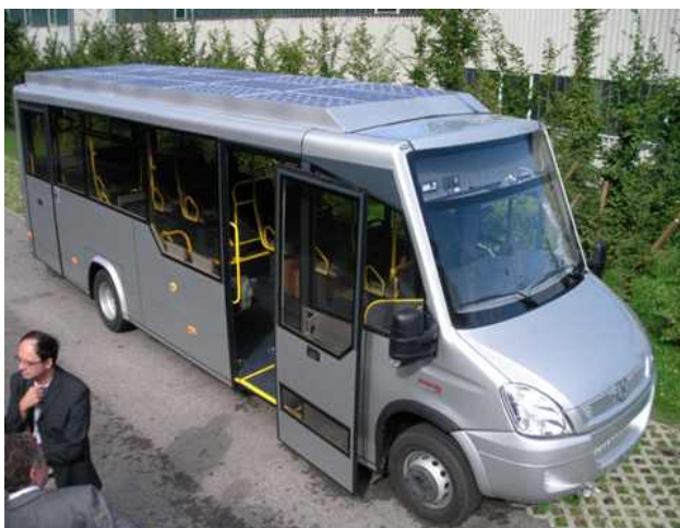
< 오스트리아 배터리 교환형 전기버스 >
