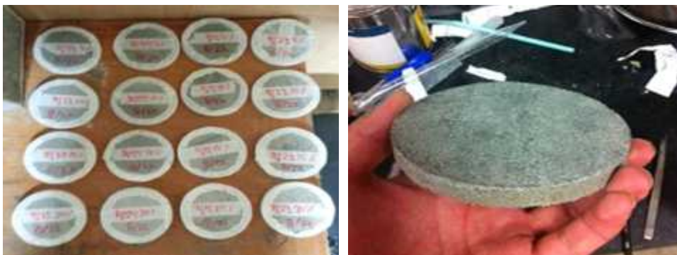
그림 128. 물흡수계수 측정용 시험체 (KS F 4716)
