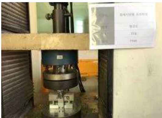
그림 12. 휨강도 및 압축강도 측정 전경
