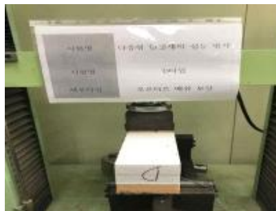
그림 58. D 타입 시험체의 실험 전경 및 응력 변형 곡선
