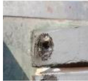
(d) 표면 가열에 의한 내부 화염 발생 (스티로폼 몸체)
