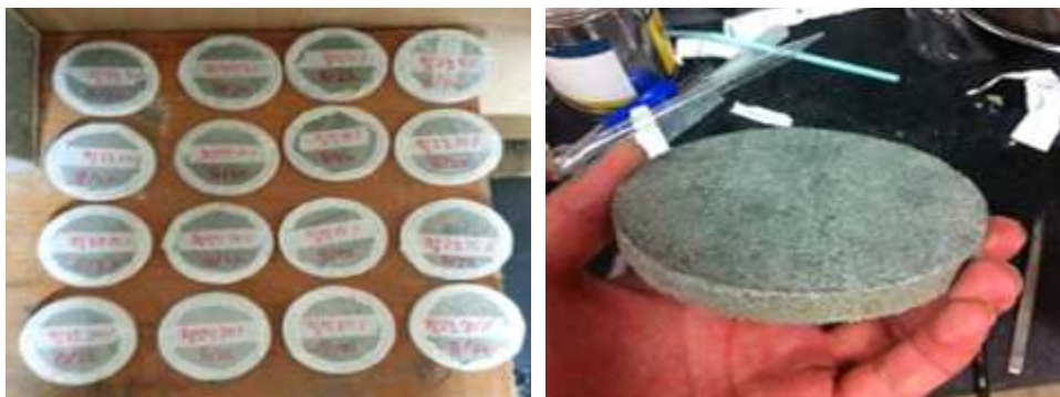
그림 67. 물흡수계수 측정용 시험체 (KS F 4716)
