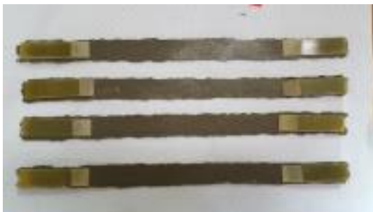
그림 47. 유리 섬유 메쉬 인장시험체 제작
