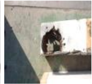
(d) 표면 가열에 의한 내부 화염 발생 (스티로폼 몸체)
