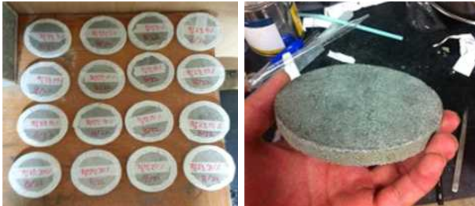
그림 15. 물흡수계수 측정용 시험체 (KS F 4716)
