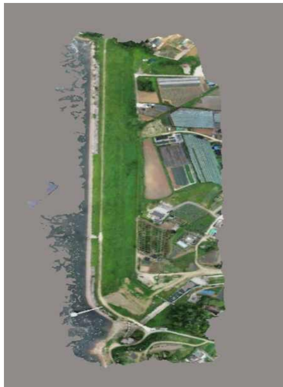
그림 2.40 토탈스테이션 측량시스템의 2D 평면도 및 드론 + LiDAR의 정밀 3차원 수치모형
