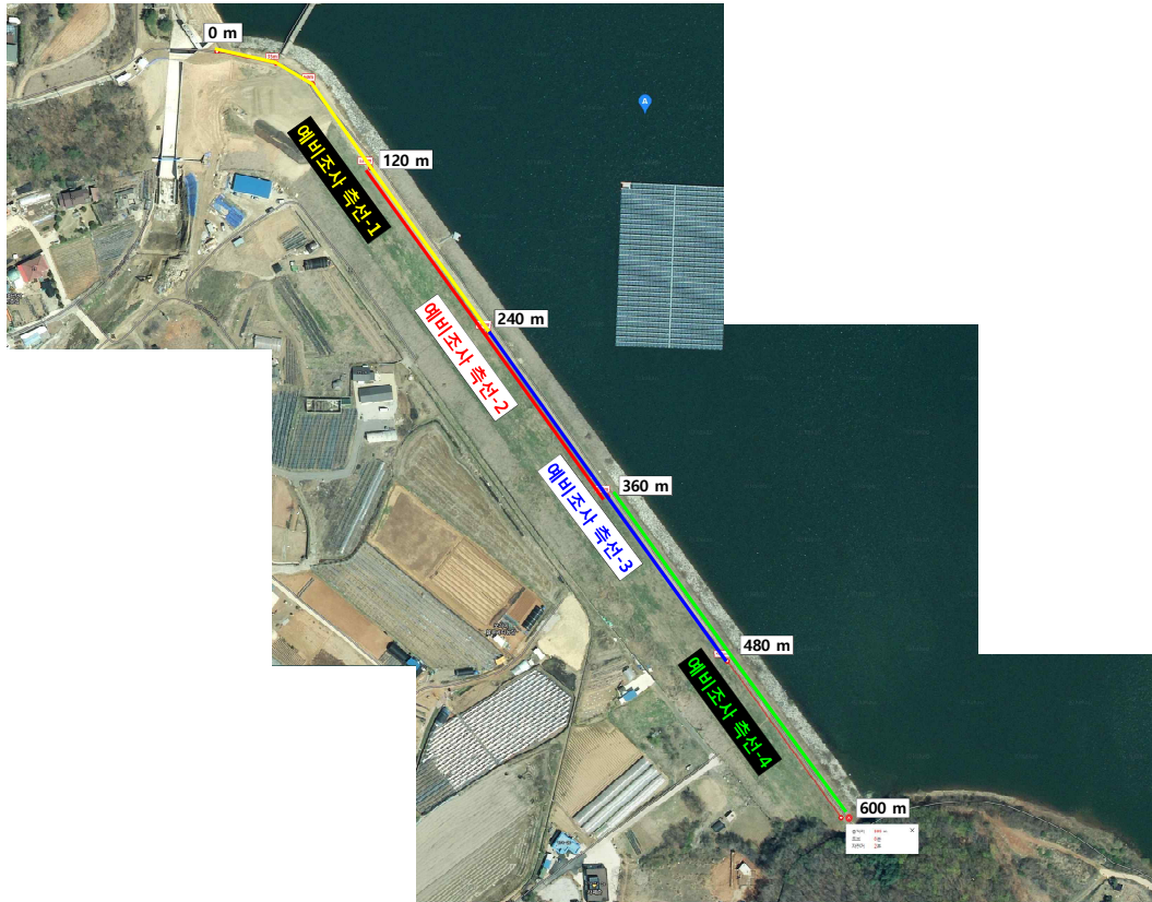
그림 2.44 길정저수지 전기비저항탐사 예비조사
