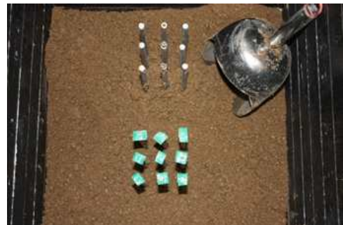
(b) 말뚝 기초 설치
