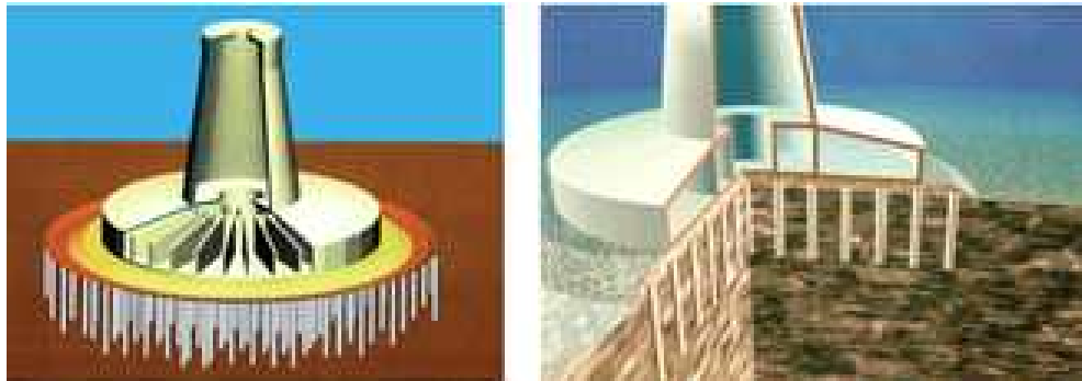
그림 29. Rion-Antirion 교량에 적용된 새로운 얇은 기초 설계
