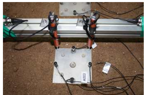
(d) 말뚝캡 설치
