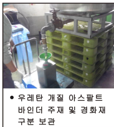
그림 2.75 우레탄 개질 아스팔트 바인더 생산 공정
