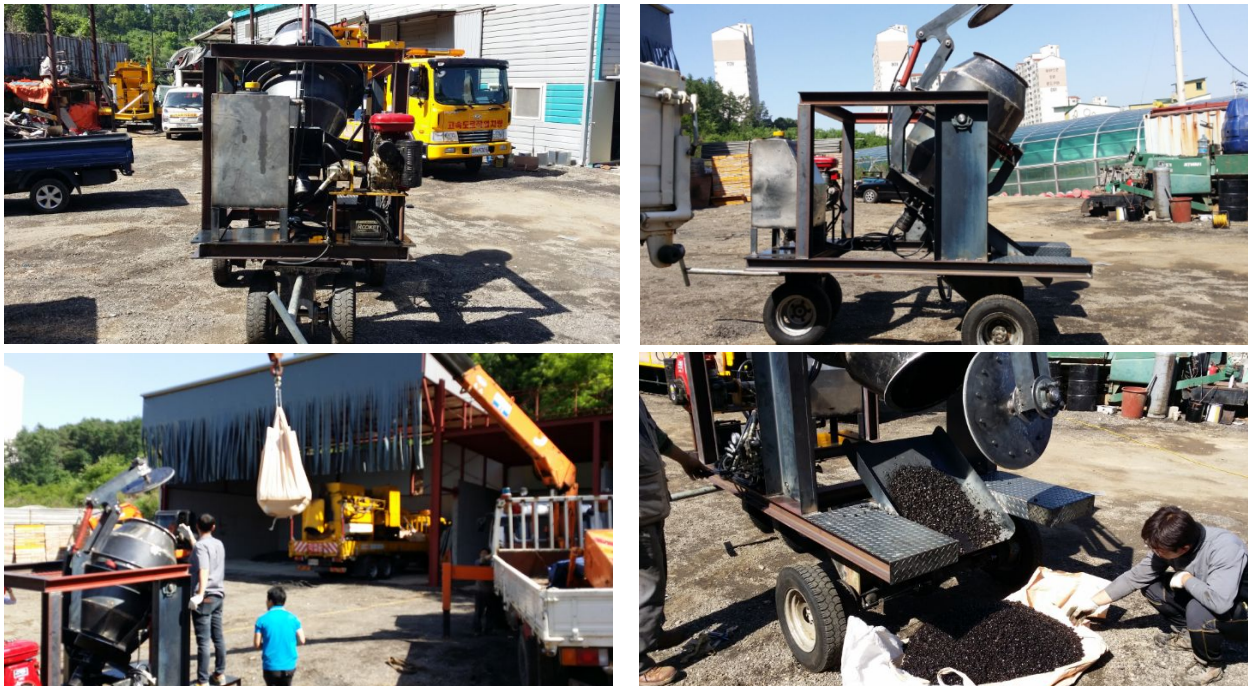
그림 2.24 우레탄 개질 아스팔트 슬러리실 혼합기 성능 점검 전경
