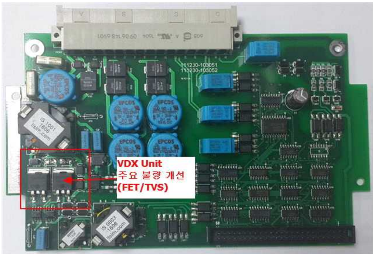
그림 17 VDX Interface B/D PCB 조립 사진(주요 불량의 개선 부위 표기)
