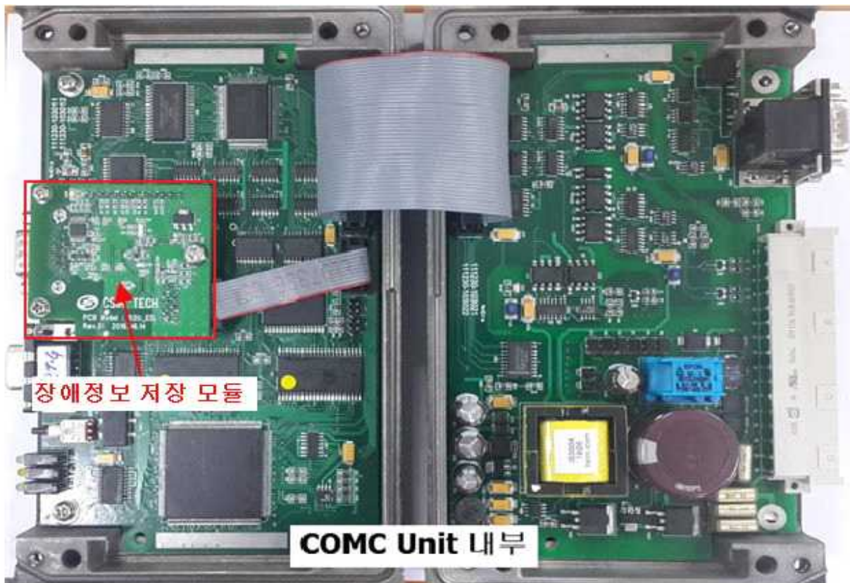
그림 12 COMC Unit 조립 내부사진(장애정보저장 모듈 취부)
