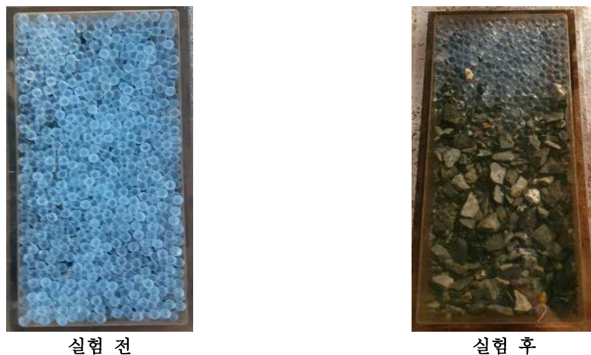
[그림 5.16] 직경 10 mm 유리구슬 실험 전후
