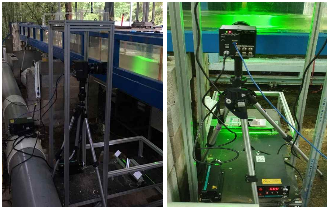
[그림 3.8] 초고속입자영상유속계 설치 전경
