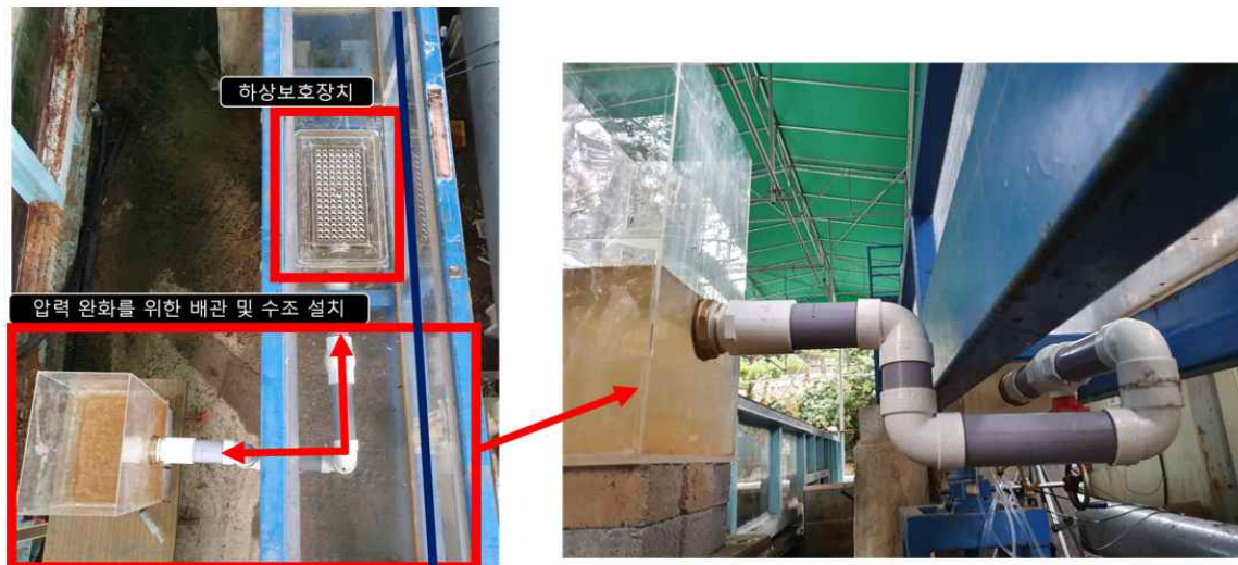
[그림 6.10] 초고속 실험 수로내 설치된 하상보호장치
