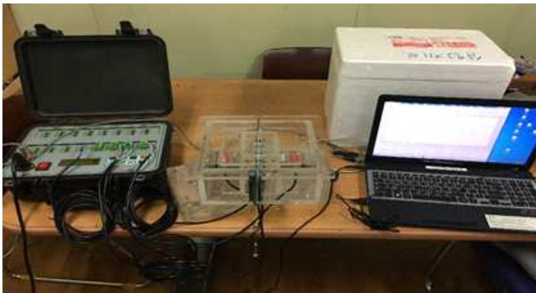
[그림 2.18] 힘의 평형 실험 장치를 이용한 3D 바닥 응력 계측기 x, y 방향 로드셀 보정 실험
