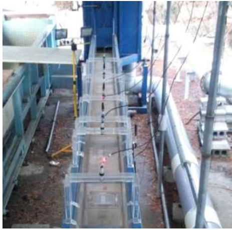
[그림 1.8] 수로 상단에 설치된 초음파 수위계 전경
