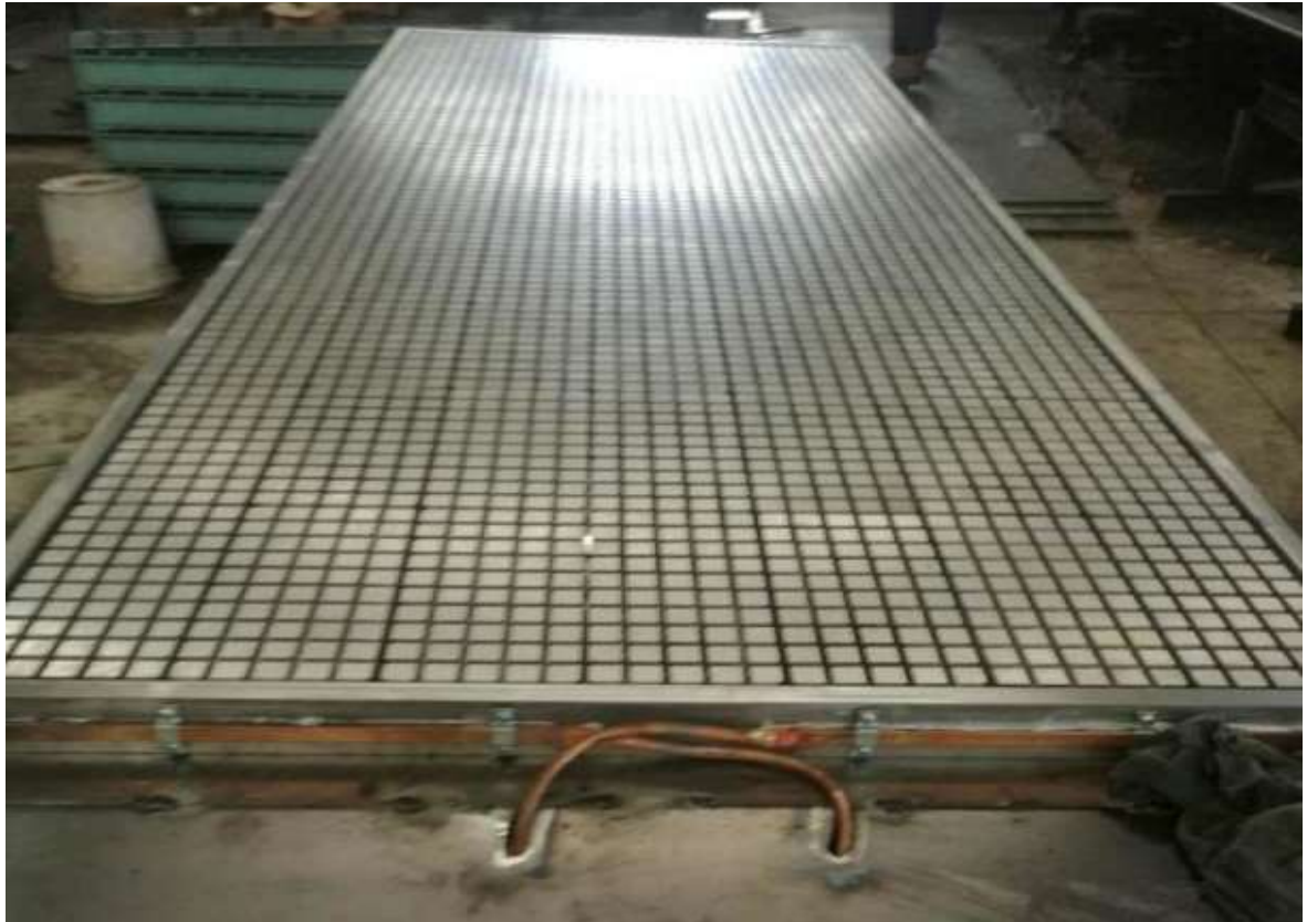
그림 3.4 비철거식 노후 옹벽 및 석축 보강공법용 식생패널 제작 금형 (2)
