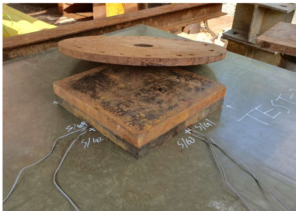
(c) 계측기기 설치
