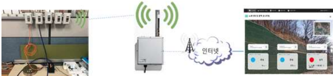
그림 3.68 유지관리 시스템 구성도
