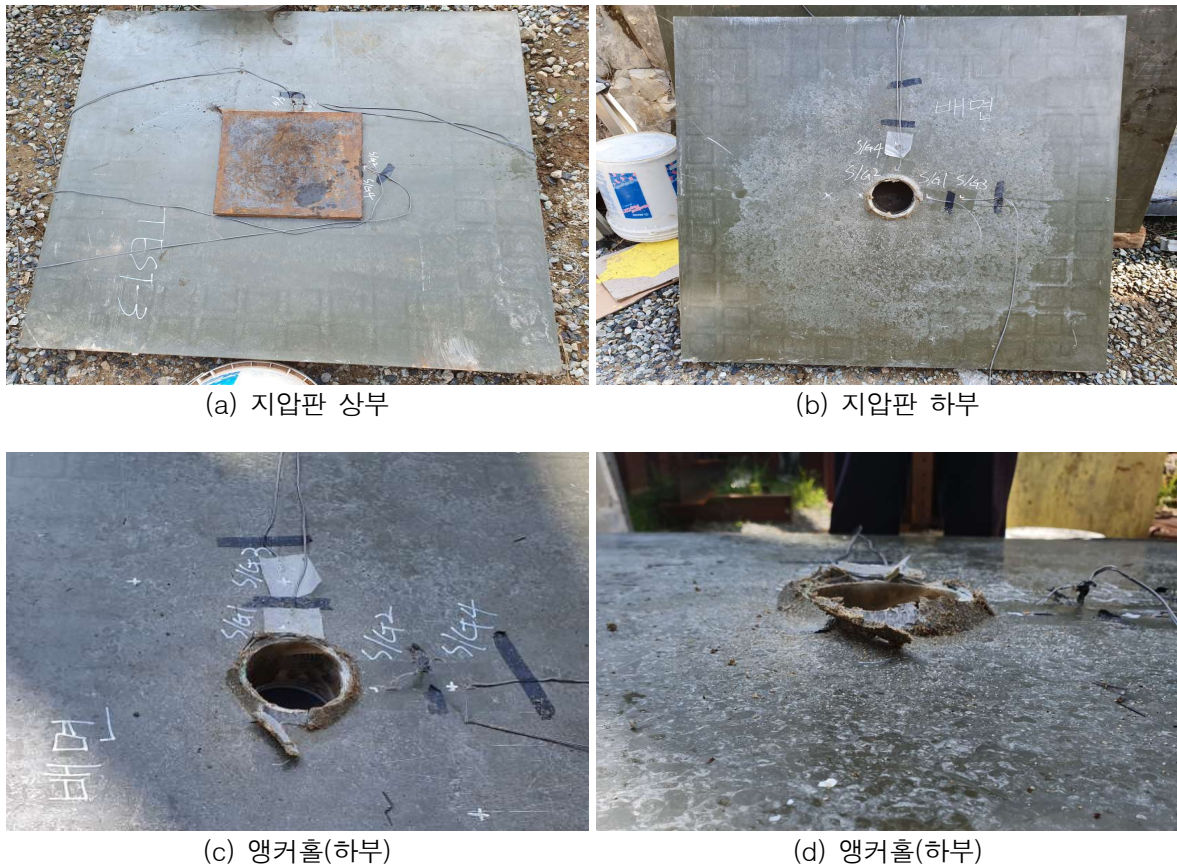
그림 3.20 복합소재 영구앵커 지압판 실물성능시험 결과
