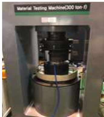
(c) 로드셀 센서 자체 하중 시험
