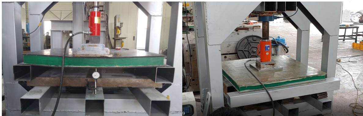
그림 3.16 복합소재 영구앵커 지압판에 대한 자체 성능시험
