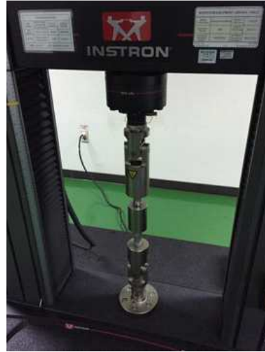
그림 39 인장시험기 및 시편 연결 Adapter
