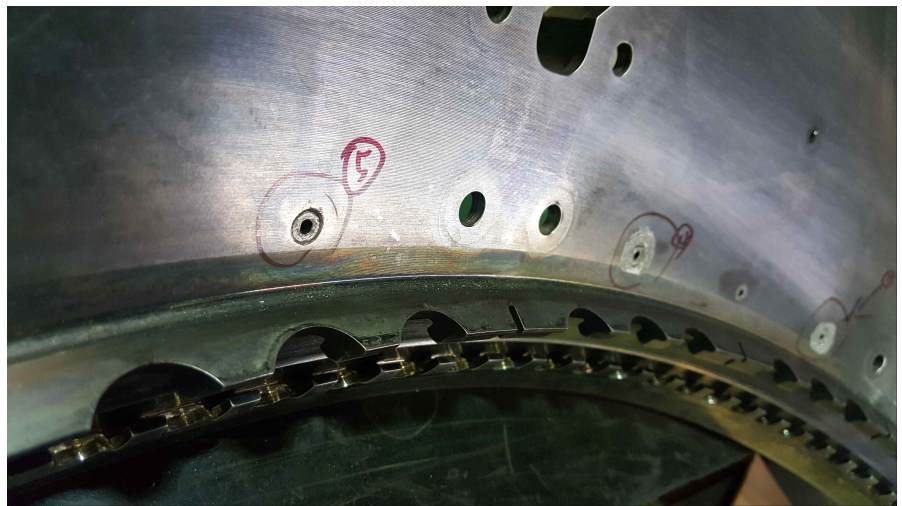
그림 58 TCF - Case Wall Wear Coating Repair
