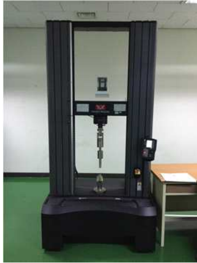
그림 39 인장시험기 및 시편 연결 Adapter
