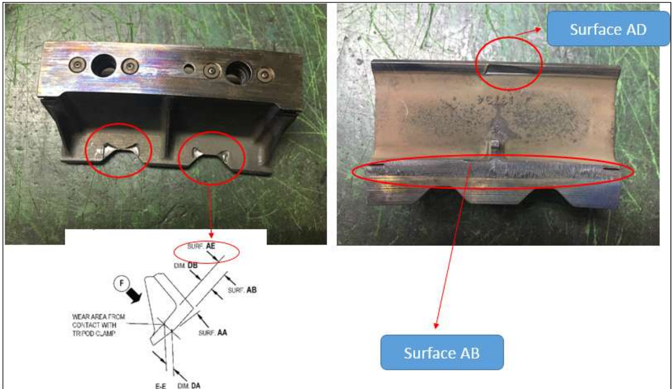
그림 60 AFT Hanger - Dimension Restoration
