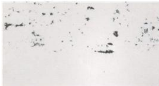
그림 118 Interface Contamination (Fine, Coarse)
