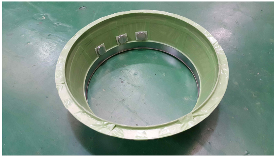
그림 109 Plasma Spray Coating 전 Masking 및 인장시험 시편
