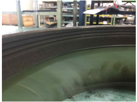
그림 166 GE90 No4 Bearing AFT Rotating Seal- Seal Land 마모
