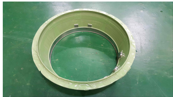
그림 168 Plasma Spray Coating 전 Masking 및 미세조직 시편
