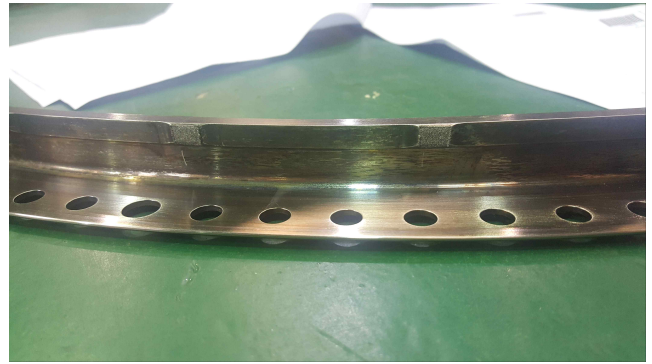
그림 61 GE90 HPT Stage 2 AFT Retainer - Diameter D Restoration
