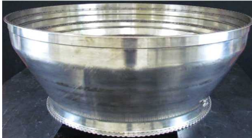
그림 189 PW4000 94인치 엔진 LPT Case
