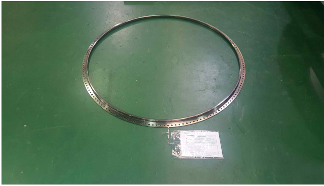
그림 61 GE90 HPT Stage 2 AFT Retainer - Diameter D Restoration
