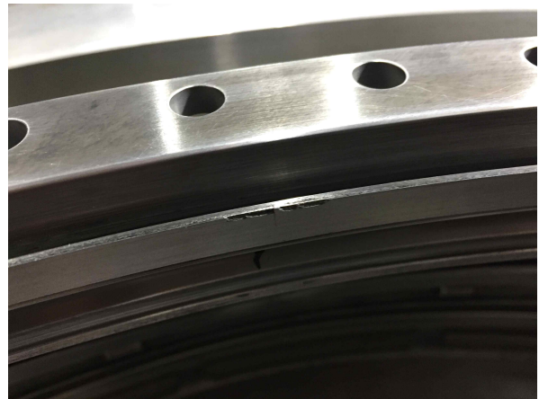
그림 88 LPT Case의 Coating Damage상태
