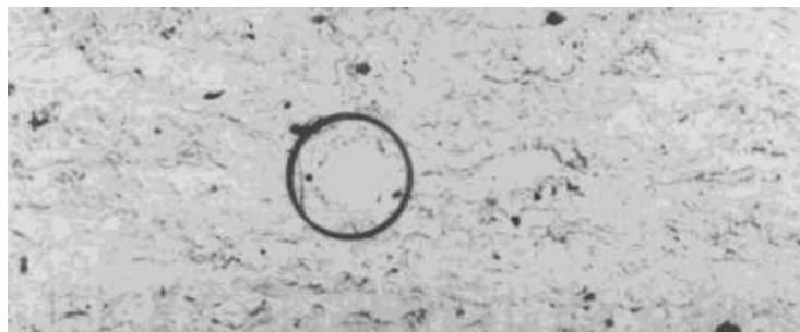
그림 66 Unmelted Particle Content 기준(200X)
