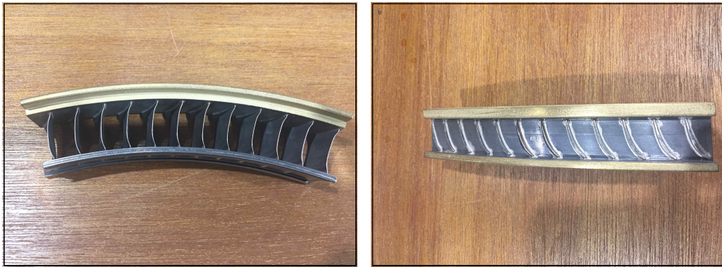
그림 147 Compressor Rear Stator Vane Sector - Outer Platform Coating
