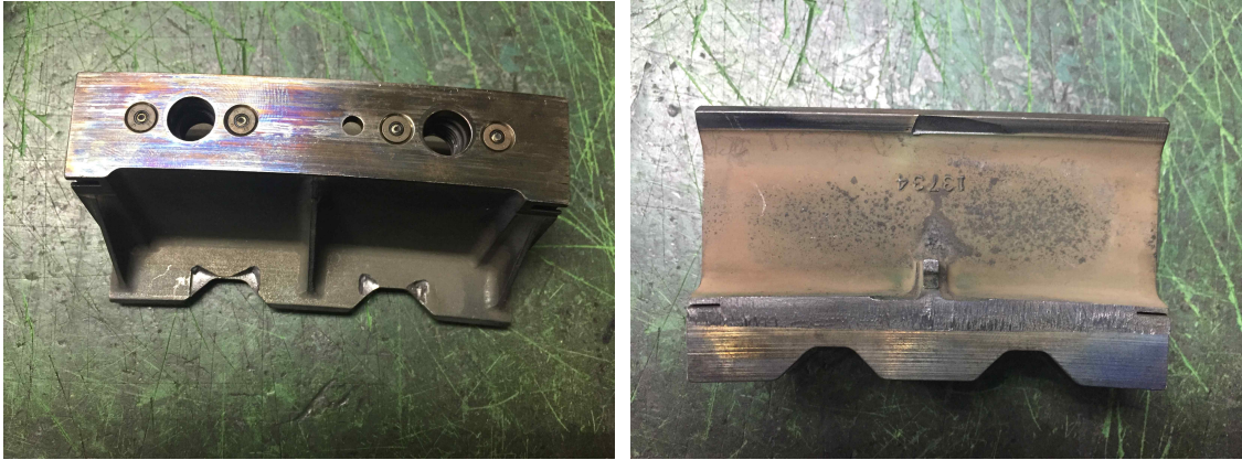
그림 246 AFT Outer Hanger Damage 현장
