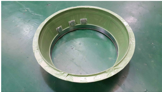
그림 167 Plasma Spray Coating 전 Masking 및 인장시험 시편
