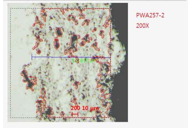
그림 50 PWA257-2 코팅 - Porosity 검사
