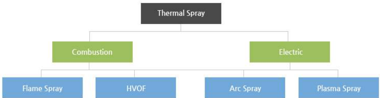
그림 12 용사(Thermal Spray) 분류표
