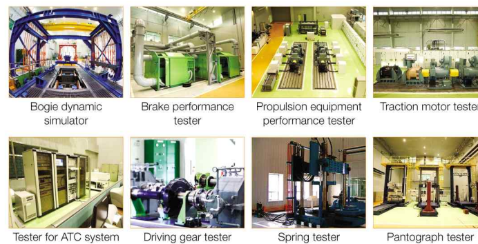
그림 2-06 국교계획을 통해 구축된 차량/전력 관련 실험장비 8종(철도연 보유)
