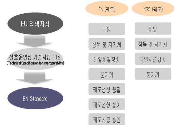
그림 3-04 범유럽 정부주도 인증체계 개념 및 궤도 분야 EN 규격의 예
