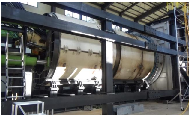
소단면 TBM 굴진 시험
