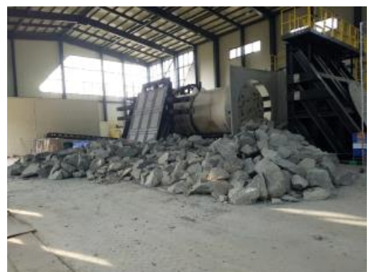
소단면 TBM 굴진 시험 후 해체
