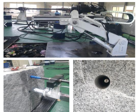
쉘드TBM 프로브 드릴 시제품 제작 및 성능검증시험
