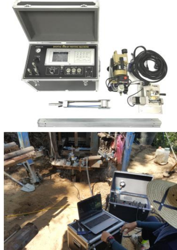
풍화대 강도특성 측정장비 개발 및 현장 검증
