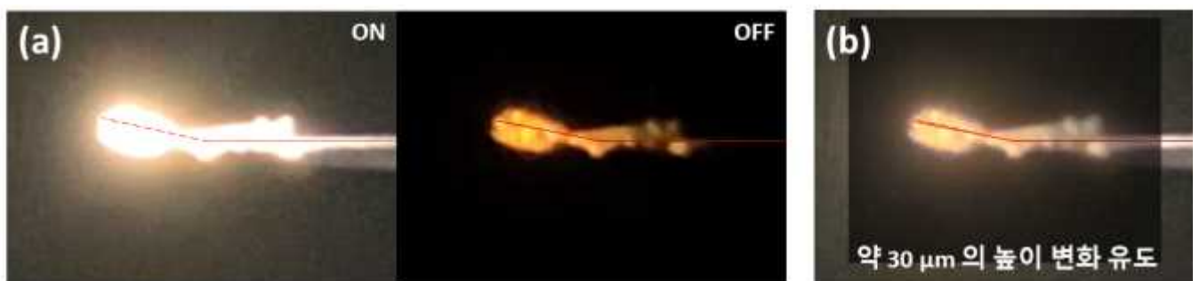
그림 3. AzoPDMS/금속 이중층 복합소재의 광급힘 성능.
