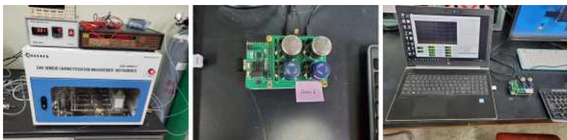
그림 29. 기존 실험실 환경에서의 측정 장비(왼쪽), 철근콘크리트 매립환경에서의 특성 분석을 위한 가스센서 임베디드 시스템(가운데, 오른쪽) 사진.
