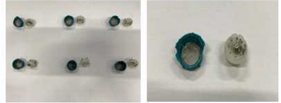
그림 64. 콘크리트 매립 환경 하에서 감지 특성 분석을 위해 제작된 센서 시스템 사진 및 콘크리트 매립안정성 시험 사진, 그리고 콘크리트 매립 후의 센서 내부 사진.
