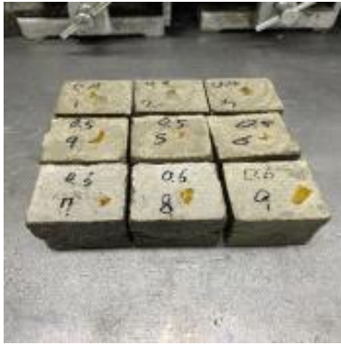
그림 42. 열화 환경 양생 전 시멘트페이스트 내 AzoPDMS 복합소재 매립 및 양생.
