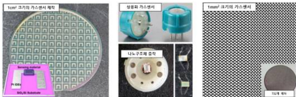
그림 28. 감지 소재가 형성된 4인치 웨이퍼 사진과 상용화 플랫폼, 상용화 플랫폼에 제작된 산화물 나노구조체 기반의 가스센서 사진.
