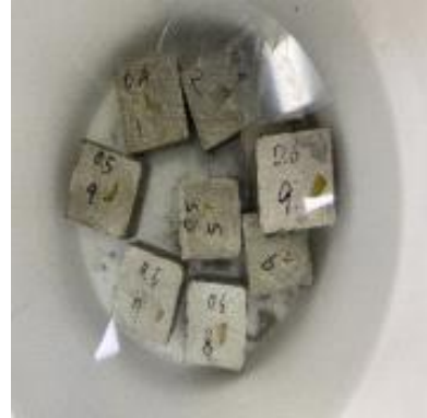
그림 42. 열화 환경 양생 전 시멘트페이스트 내 AzoPDMS 복합소재 매립 및 양생.
