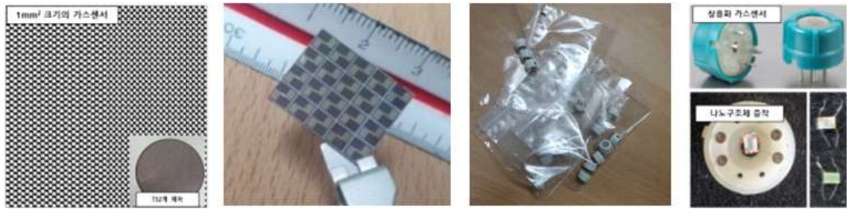
그림 61. 초소형 가스센서 전극 디자인과 제작된 기판, 그리고 단일 센서의 패키징 사진
