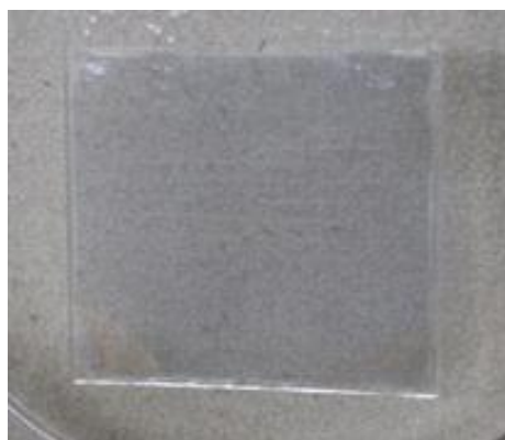
그림 9-1. cross-cut법 완료 후 \text{SiO}_2\text{-TiO}_2(\text{EtOH}) 표면 상태
