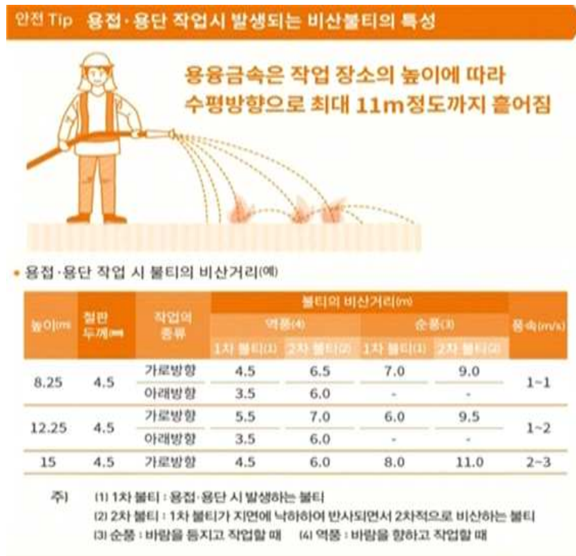
그림 2-6. 용접 용단 작업시 발생하는 비산불티의 특성
