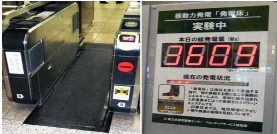
<그림 86> 도쿄 지하철의 발판용 압전발전 장치 및 전력계 모습
