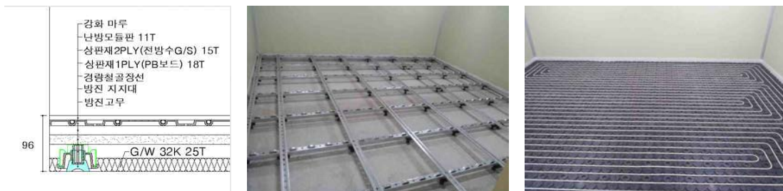
그림 2-18. 건식바닥 단면도(좌), 하부지지구조(중), PB배관시공(우)
