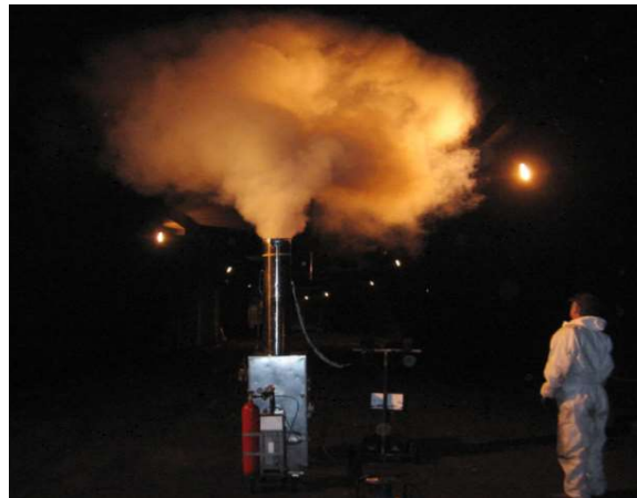
그림 1-48 환기 테스트를 위한 연기 생성장치
