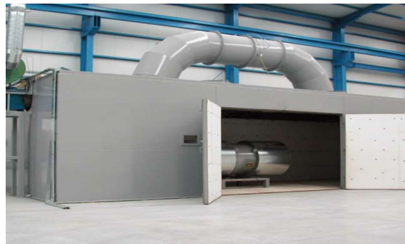
그림 1-50 고온 팬 테스트
