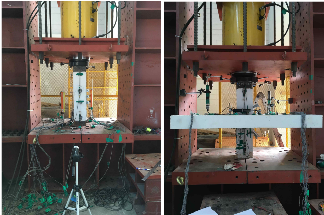
[그림 39] 실험체 설치 상황
