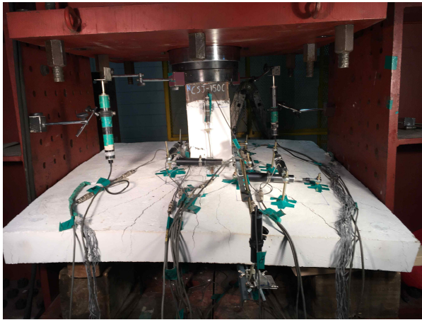
[그림 47] 슬래브 조각간 상대변위 측정
