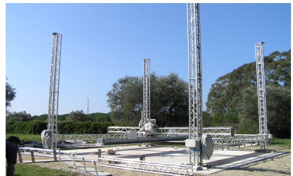
그림 23. 엔리코 다니가 개발한 건축물을 위한 3D 프린터 ‘d-shape’
