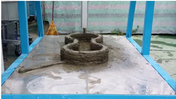
(a) 실험체의 프린팅 모습
