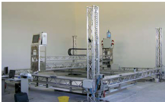
그림 23. 엔리코 다니가 개발한 건축물을 위한 3D 프린터 ‘d-shape’
