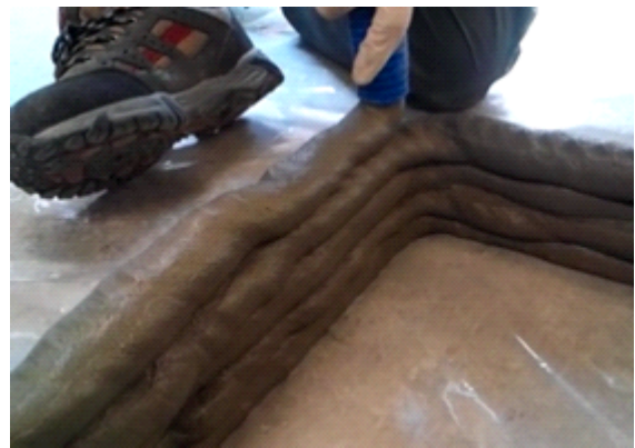
(b) 모의실험체의 적층 모습
