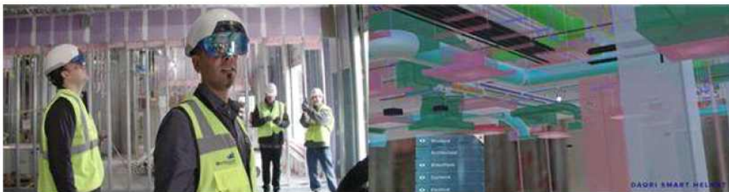
〈그림 37〉 DAQRI 헬멧으로 본 설비/구조 증강현실 현장 [출처 : DAQRI 2016]
