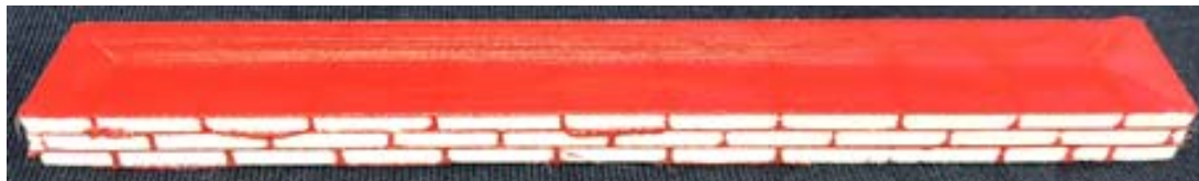
그림 16. Platelet의 길이를 네 배 늘린 적층형 복합재 구조 - 시편 6
