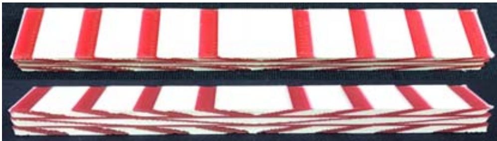
그림 12. Voronoi diagram의 적용 없이 개발한 진주층 모사 시편 - 시편 2
