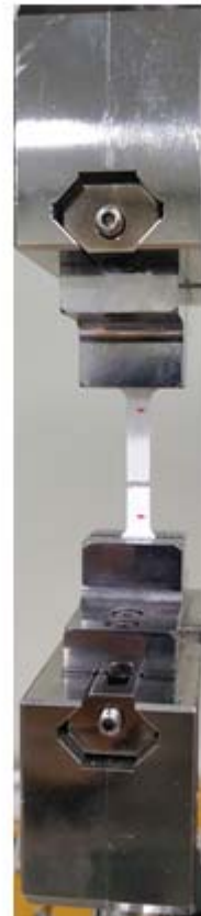
그림 25. TPU와 PLA의 인장시편과 인장실험의 수행 (한밭대학교)
