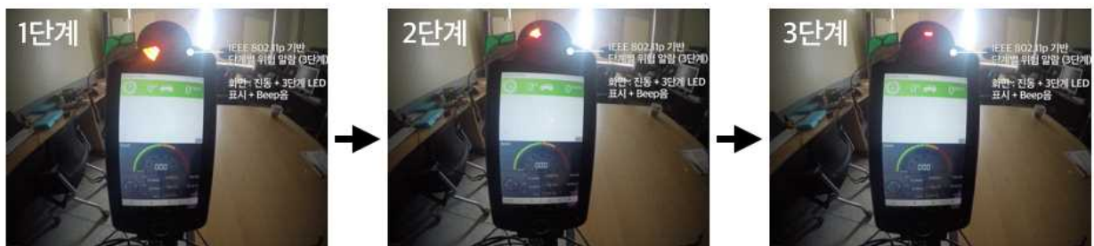
<그림> 단계별 이벤트 알람 (LED 모듈 + 진동 모듈 + 추가 정보창 연동)
