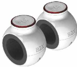
<위험요소 접근 정보 알림을 위한 촉각(진동)및 청각(스피커) 장치>
