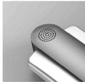
<위험요소 접근 정보 알림을 위한 촉각(진동)및 청각(스피커) 장치>
